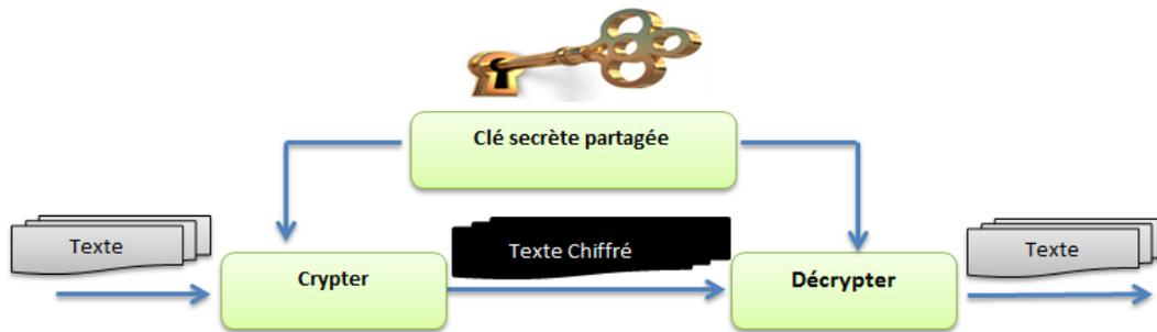
FIGURE 2.2 – Le chiffrement à base de clé symétrique
