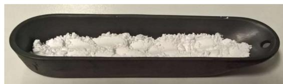
Figure 40 Zéolithe dans le creuset avant insertion dans le four
