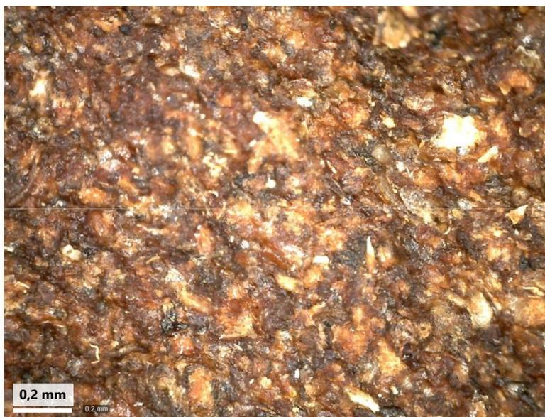
**FIGURE III.3-27.** Image d'un composite de cosses de cacao obtenue à l'aide d'un microscope optique (grossissement  $\times 240$ ).
