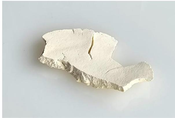
**FIGURE III.3-3.** Photographie d'un biocomposite de poudre d'arêtes de poissons et du mélange K6.
