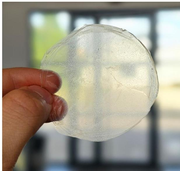
**FIGURE II.2-2.** Photographie d'un film obtenu par méthode de casting.
