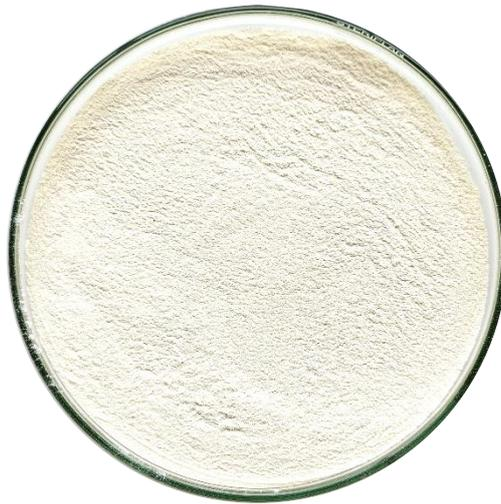
**FIGURE II.1-3.** *Poudre d'arête de poissons utilisée.*
