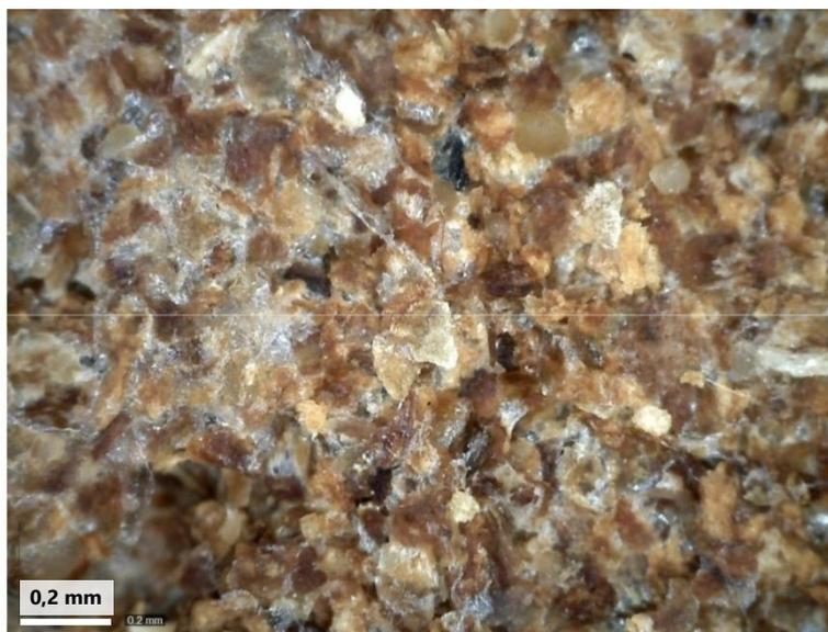
**FIGURE III.3-11.** Image d'un composite de drêche de pomme obtenue à l'aide d'un microscope optique (grossissement  $\times 240$ ).
