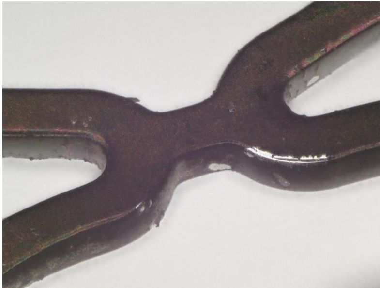
Figure 44. Aspect microscopique (VHX) de l'armature CoCr des stents rudimentaires après 22h de dip coating.
