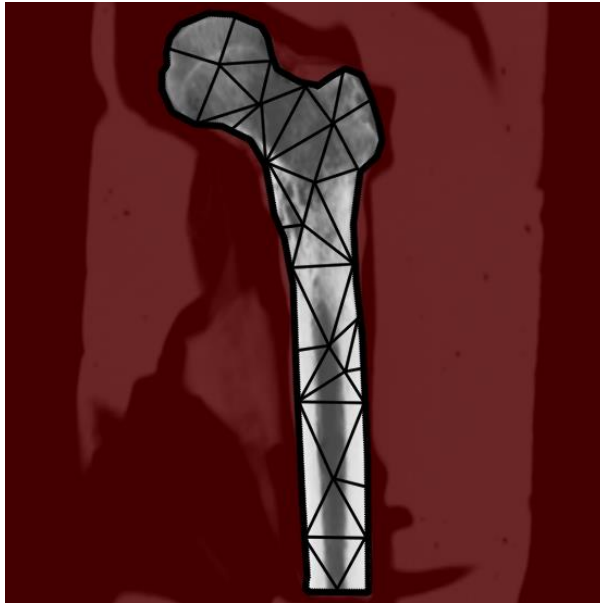
Figure 36: Illustration 2D d'un maillage simplifié (pour la clarté de l'explication) superposé à une coupe de scan tomodensitométrique d'un fémur.
