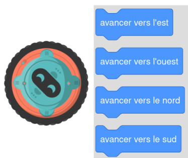
FIGURE 7.6 – Exemple de robot et commandes de déplacement en orientation absolue
