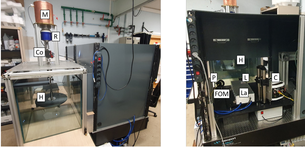
FIGURE 8.1 – Photo de côté (à gauche) et de face (à droite) du dispositif expérimental. Un faisceau cohérent produit par le laser (La) est agrandi par une lentille de microscope pour illuminer la face avant d’une cuve cubique remplie de suspension de \text{TiO}_2 (absente ici). La lumière rétrodiffusée est collectée à travers un polariseur (P) par la caméra haute vitesse (C) dont la mise au point est effectuée à l’interface entre le fluide et la cuve. Un speckle de lumière rétrodiffusée en champ lointain est également sélectionné à travers un polariseur (P) par une fibre optique monomode (FOM) reliée à un tube photomultiplicateur et à un corrélateur (non visibles ici). Dans la cuve, une hélice (H) circulaire à 4 pales droites est mise en rotation par un moteur (M) relié à un réducteur 20:1 (R). Un couplomètre (Co) permet de mesurer le couple appliqué à l’arbre et à l’hélice.
