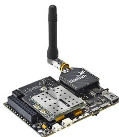
**Figure II.11:** Noeud de capteurs Wasmote
