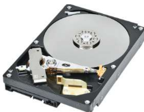
FIGURE 1.1 – Exemple d'un disque dur à plateau [10]
