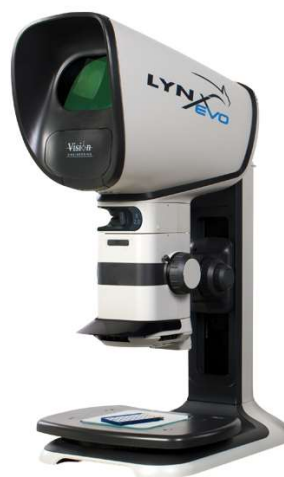
(b) Stéréo-microscope sans oculaire Lynx EVO [138]
