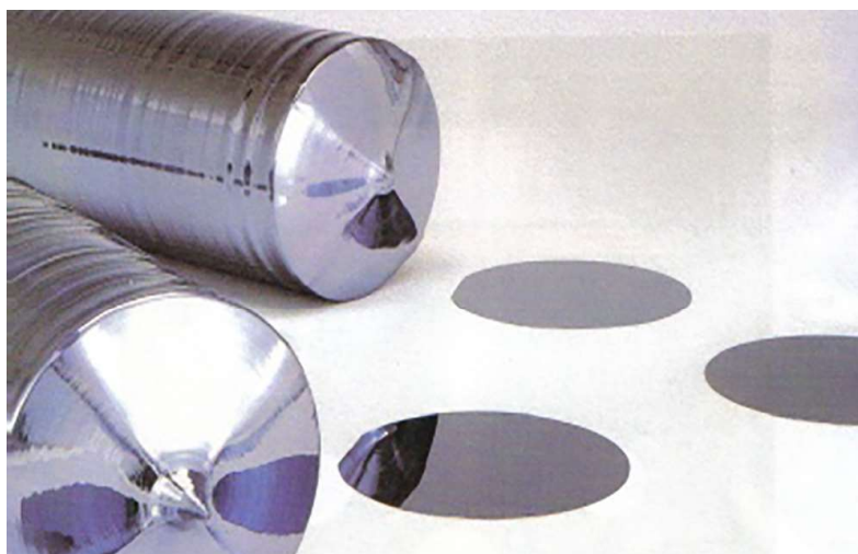
FIGURE 1.54 – Exemple d'un wafer de silicium, tranche de silicium servant de substrat lors de la fabrication des composants électroniques [46]
