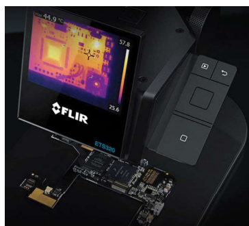
(b) Caméra milieu de gamme FLIR ETS320 [142]
