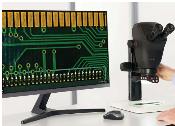
FIGURE 1.8 – Exemple d'utilisation d'une binoculaire pour observer une carte électronique [13]
