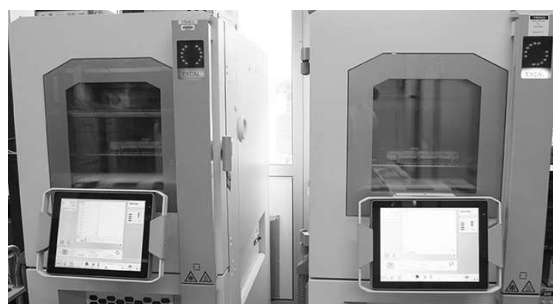
(a) Étuve de vieillissement de composants [108]
