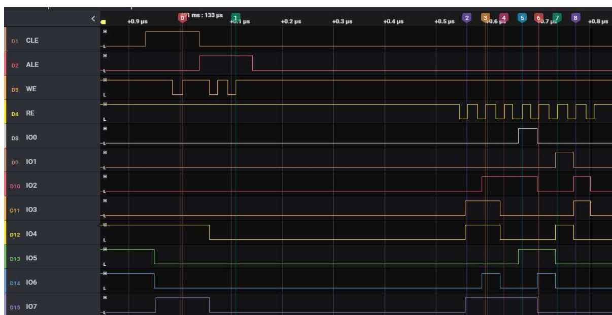
FIGURE 3.22 – Zoom sur la commande READ_ID permettant d’identifier l’ensemble des signaux
