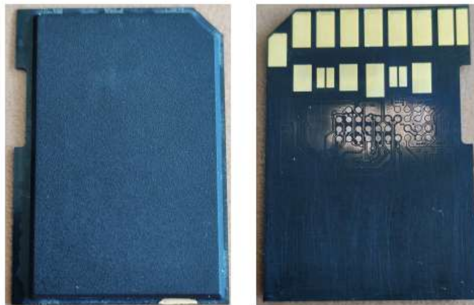
FIGURE 2.12 – Vue optique des faces avant et arrière d'une carte SD provenant d'un cas réel, dans l'état dans lequel elle a été réceptionnée
