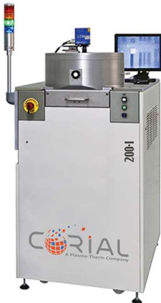
FIGURE 1.41 – Exemple de machine de gravure plasma de la marque Corial [33]
