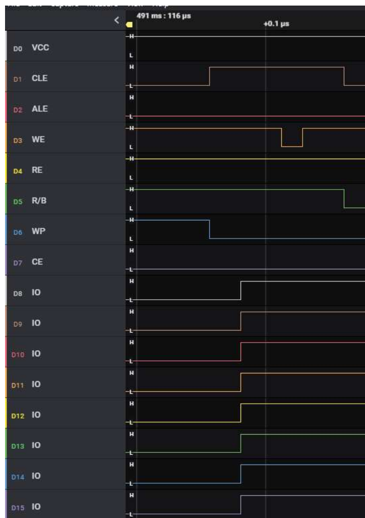
FIGURE 3.21 – Zoom sur la commande RESET permettant d'identifier les signaux Command Latch Enable (CLE) et Write Enable (WE)
