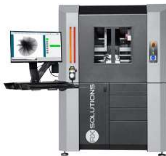
FIGURE 1.14 – Exemple de machine à Rayons-X pour la visualisation 2D et 3D de marque RX Solutions [17]
