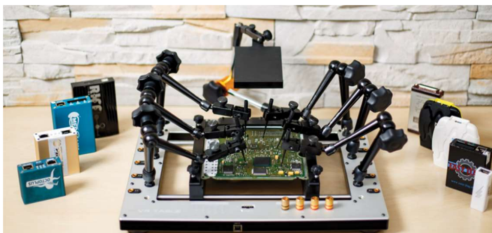
FIGURE 1.49 – Station de probing entrée de gamme de la marque VR Table [40]
