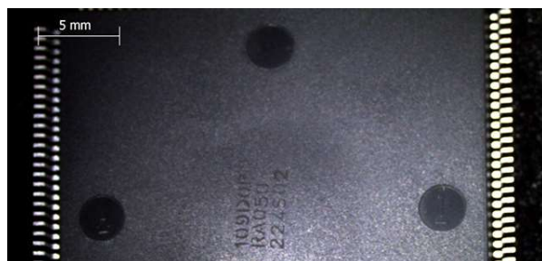
(a) Défaut suite à une délamination : formation d'une bulle dans la résine [114]
