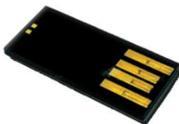
FIGURE 1.3 – Exemple d'une clé USB monolithe [11]
