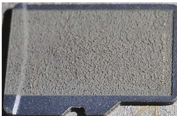
FIGURE 1.39 – Exemple de gravure laser pour amincir la résine à la surface d'une carte microSD
