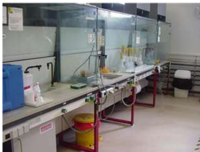
FIGURE 1.36 – Exemple d'espace de manipulation chimique pour le traitement des composants électroniques
