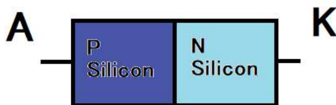
FIGURE 1.55 – Illustration de la jonction PN dans un substrat de silicium
