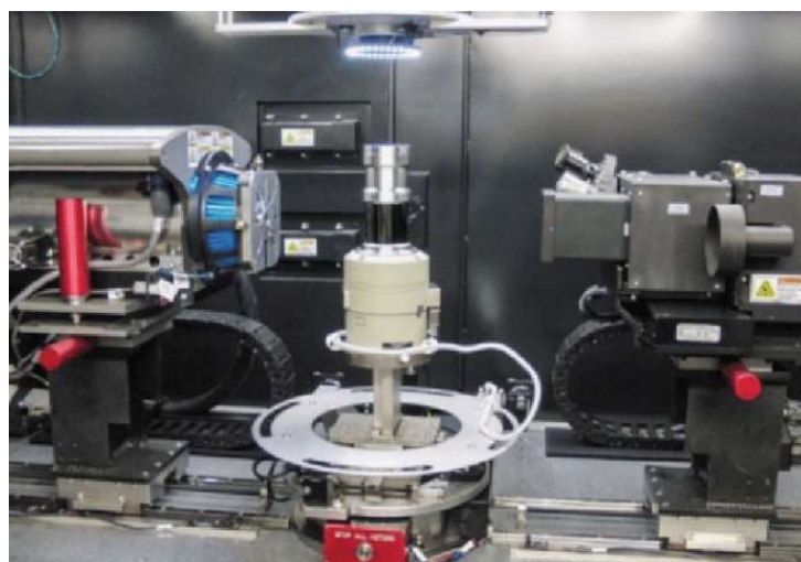
FIGURE 1.13 – Exemple de positionnement d'un échantillon dans une cabine de rayons-X de marque Zeiss [16]
