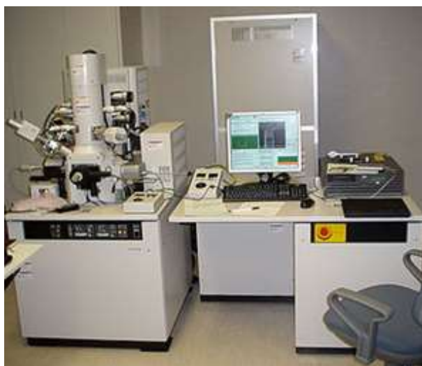
FIGURE 1.43 – Exemple d'un équipement FIB [34]
