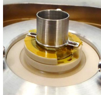
Figure VI-19 : Scotch Kapton entre l'Anode et G2
