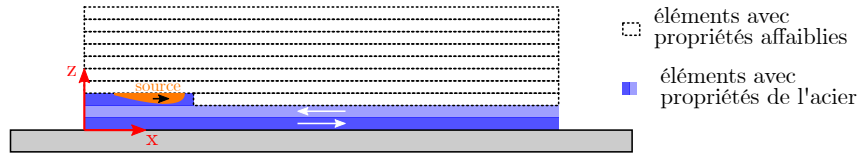
Figure 6.14 – Modélisation de l'apport de matière pour la stratégie de dépôts enchaînés.
