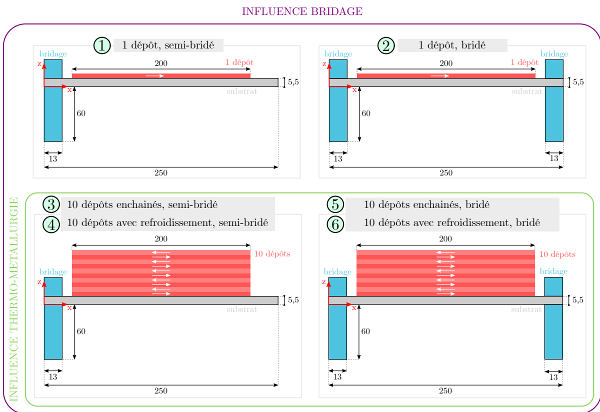
Figure 3.2 – Stratégies de dépôts définies pour étudier l'influence du bridage et de l'histoire thermo-métallurgique sur la genèse des contraintes et des déformations résiduelles.
