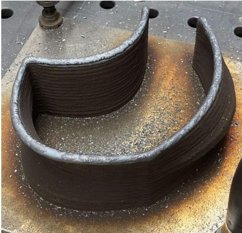
Figure 7.21 – Fabrication d'une pièce de 35 dépôts et de géométrie complexe en acier inoxydable martensitique 415.
