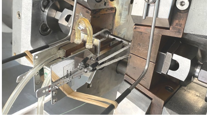
Figure 5.6 – Montage expérimental d'un essai de traction à 20 °C et mesure de la déformation avec un extensomètre longitudinal.
