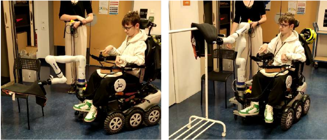
FIG. 5.7 – Nolann, s'entraîne ici à une des tâches du Cybathlon : attraper une serviette et la pendre sur un montant. Le bras Kinova est fixé sur le flanc de son fauteuil et piloté par la tablette posée sur ses genoux.
