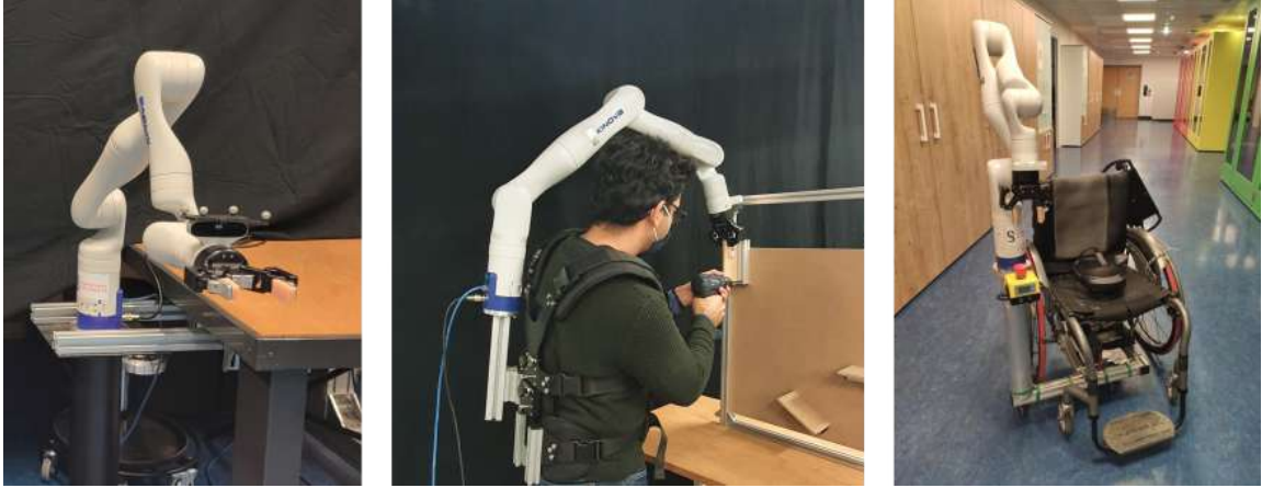
FIG. 2.1 – Exemples de positionnement du Kinova : fixe attaché à une table, porté par l'utilisateur, ou posé sur une base mobile tel qu'un fauteuil roulant.
