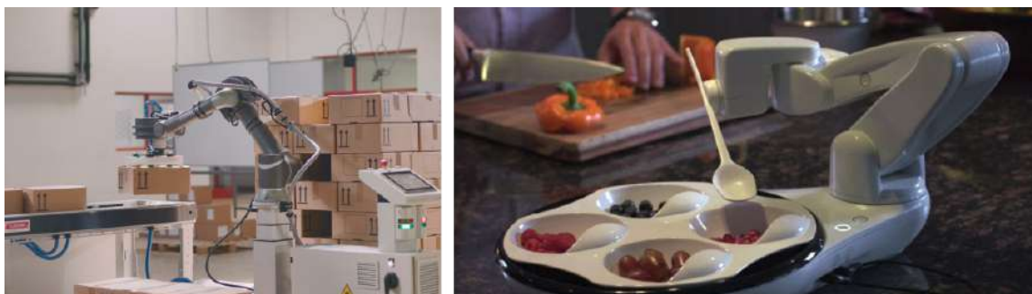
FIG. 1.1 – Un robot de palettisation Omron (à gauche) et un robot Obi pour l'aide au repas (à droite), tous deux évoluant proches de l'humain mais en autonomie quasi-totale de leurs utilisateurs.
