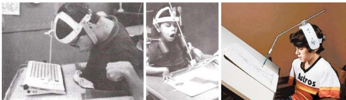
FIG. 1.4 – Exemples de baguette de tête. A gauche et au centre, des baguettes [31] pour utiliser un clavier ou dessiner. A droite, une version plus récente et commercialisée [32].
