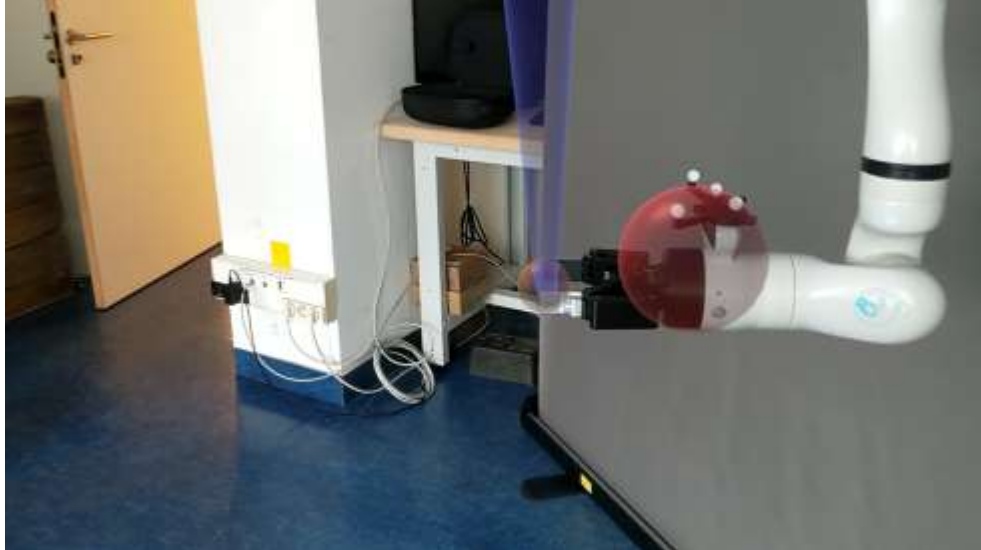
FIG. 4.13 – La visualisation depuis le casque : le lien virtuel (en bleu), son effecteur (sphère bleue), l'effecteur réel du robot (sphère orange) et la cible à atteindre (sphère rouge).
