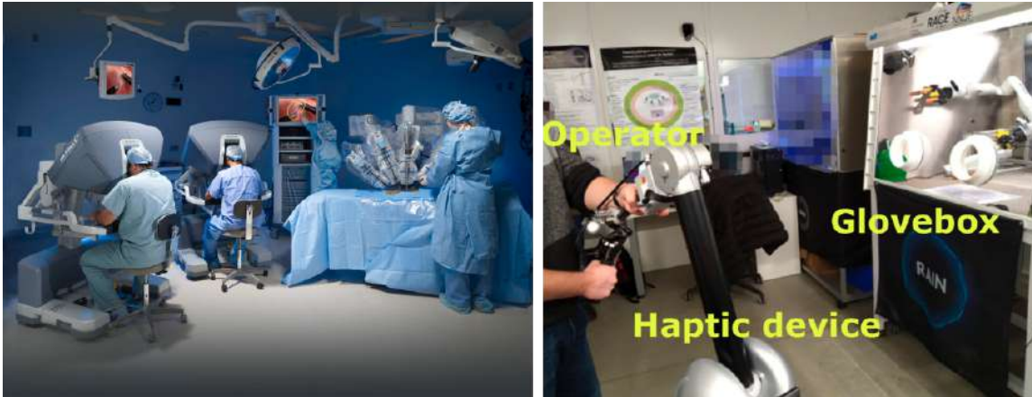
FIG. 1.3 – A gauche, un robot Da Vinci, téléopéré à distance pour la laparoscopie. A droite, une interface Haption permet de commander un bras robot situé dans une boîte à gant (où un second opérateur interagit généralement via des gants).
