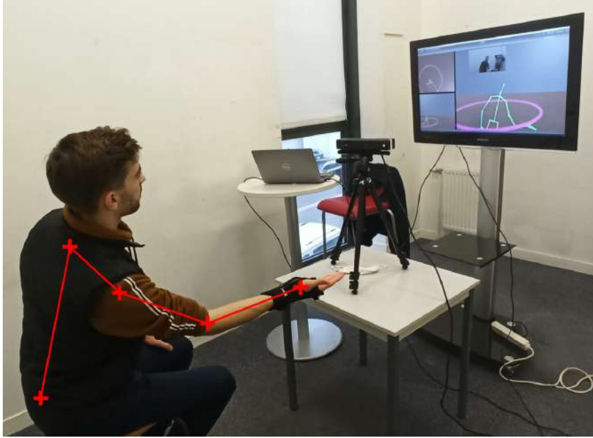
FIG. 4.6 – Capture des postures via Kinect de Microsoft. Le sujet visualise des cibles qu'il doit atteindre, d'abord librement, puis avec des instructions contraignant ses angles de coude et de poignet.
