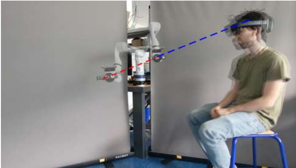
FIG. 4.14 – Un exemple de reconfiguration du lien : pour des positions très similaires du sujet, deux cibles distinctes sont atteintes, grâce à l'allongement (en rouge) du lien virtuel initial (en bleu).
