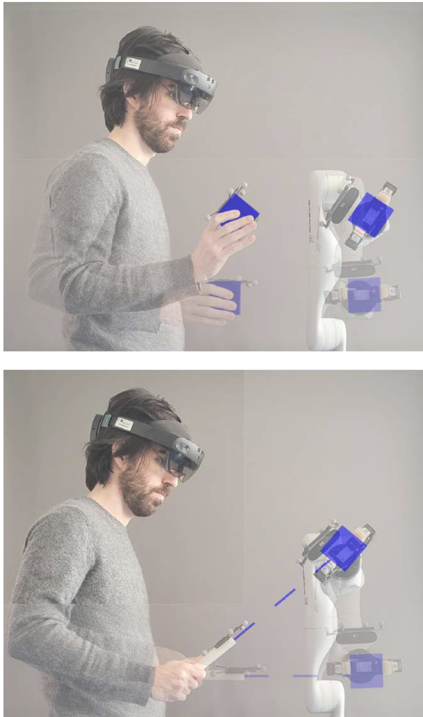
FIG. 2.4 – Un exemple de comparaison du couplage RDM et LV, où deux mouvements humains différents conduisent à des mouvements de l'effecteur robot similaires.
