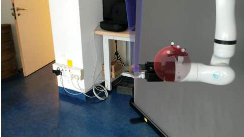
FIG. 4.13 – La visualisation depuis le casque : le lien virtuel (en bleu), son effecteur (sphère bleue), l'effecteur réel du robot (sphère orange) et la cible à atteindre (sphère rouge).
