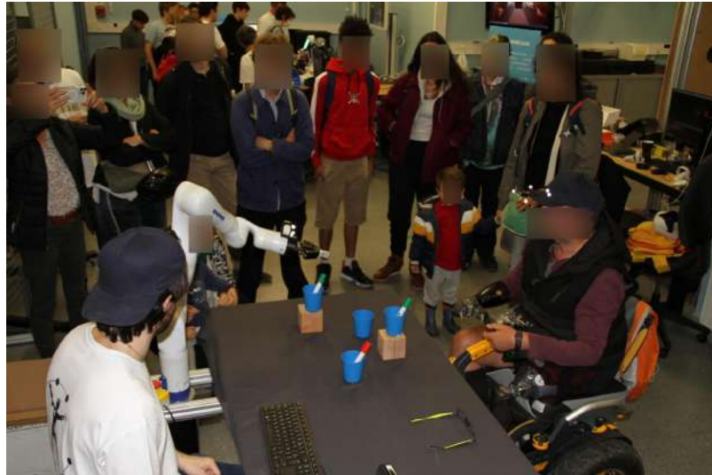
FIG. 5.1 – Un visiteur lors de la fête de la science (portes ouvertes du laboratoire) : un marqueur Optitrack sur la casquette permet de détecter les mouvements de tête, et le robot, posé en face du participant, est piloté via le couplage LV lié à la tête. La tâche proposée consistait à saisir et déplacer des feutres dans plusieurs verres, la pince étant activée ici par une pédale de pied (signal binaire, chaque clic ouvrant ou fermant la pince). Par souci de mise en place (batterie, fragilité), le casque AR n'était ici pas utilisé.
