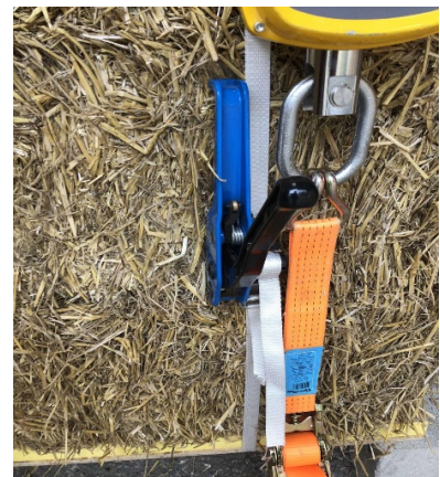
(c) Sangle à cliquets et sangle définitive en polypropylène
