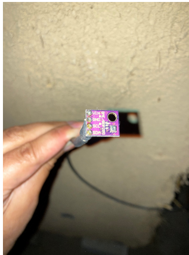
(c) Capteurs d'humidité et de température insérés entre deux bottes
