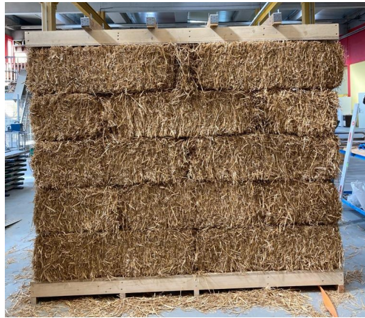
FIGURE 53. Montage du mur avant précompression
