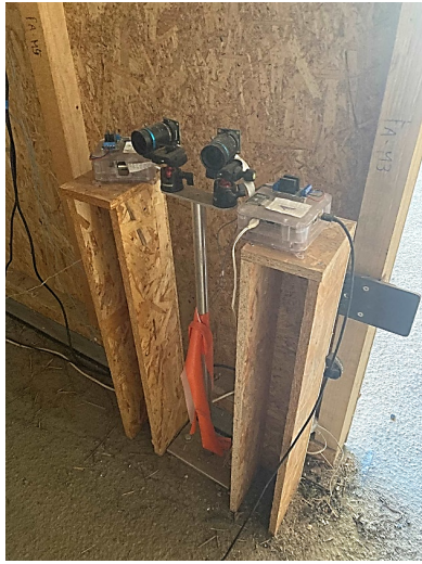
(a) Boîtiers Raspberry Pi (2 ou 3B) et modules de relais 5V fixés sur le couvercle supérieur, caméras et téléobjectifs de 16 mm fixés sur leurs supports métalliques
