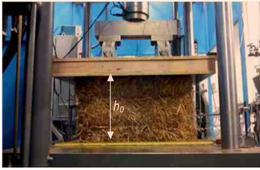
(a) Essai sur chant au début de l'essai
