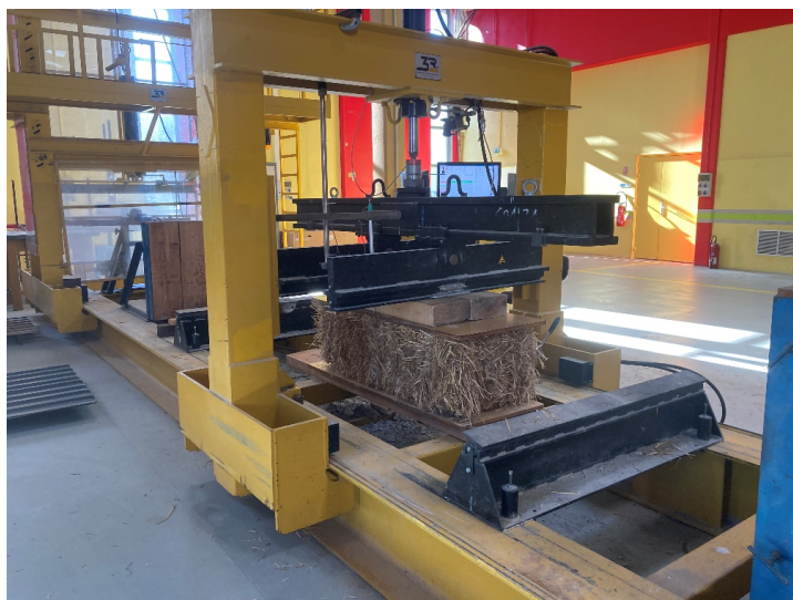
FIGURE 3.3. Dispositif d'essai de compression sur bottes
