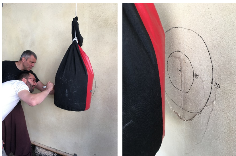
FIGURE 2.31. Essais d'impact sur un mur enduit – (Source : Quirant et al. (2018))
