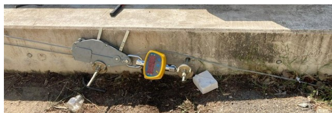
FIGURE 3.24. Mesure de l'effort par dynamomètres
