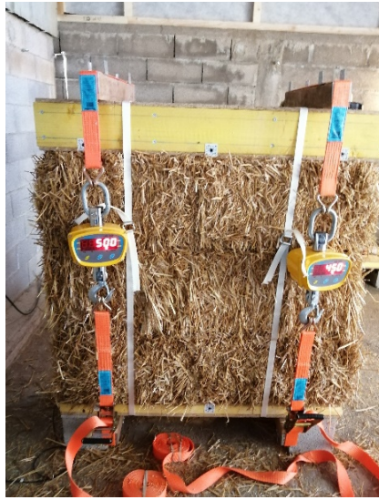
FIGURE 3.15. Préchargement des murs avec des sangles à cliquet
