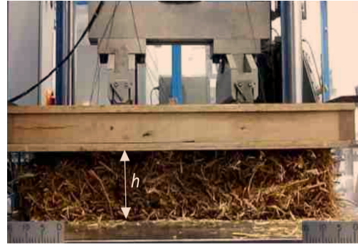
(b) Essai à plat avec une déformation de 0,77
