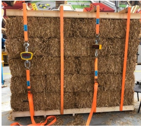
(a) Insertion des dynamomètres et précompression
