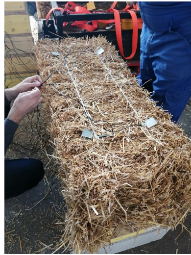
(b) Capteurs de pression plats stabilisés sous les ficelles
