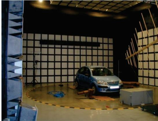
Figure 18: Véhicule Citroën lors d'un test d'immunité dans une chambre semi-anéchoïque
