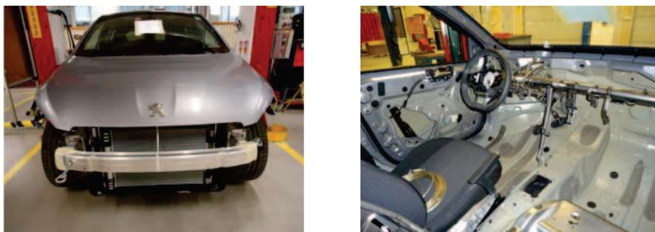
Figure 33 : Caisse véhicule simplifiée
