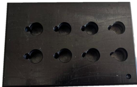
Figure 2.8. Plaque bi-puits conçu par Karim Benmlih utilisée pour les tests de suivi de libération du peptide par fluorescence
