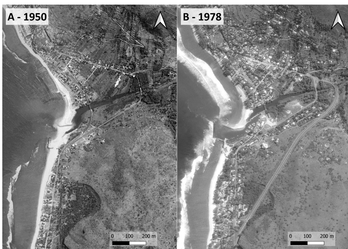
Figure 2-21 : Evolution des plages Roches Noires et Brisants : Modification du paysage littoral avec la construction du port. Orthophotographies IGN, campagnes A : 1950 , B : 1978
