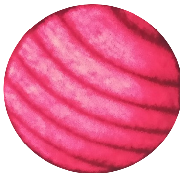
FIGURE 4.12 : Exemple d'une figure d'interférence obtenue par interférométrie de Fizeau. L'intervalle entre deux franges noires correspond à une différence de marche de \lambda/2 . Cette figure est une cartographie de la planéité de la surface analysée où les franges sont les gradients de hauteur.
