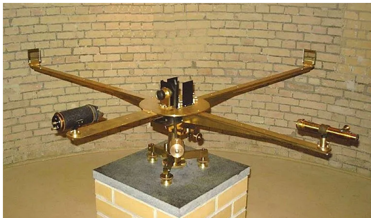
FIGURE 2.23 : Photo de l'expérience de Michelson (© 2005 MAZ Potsdam)
