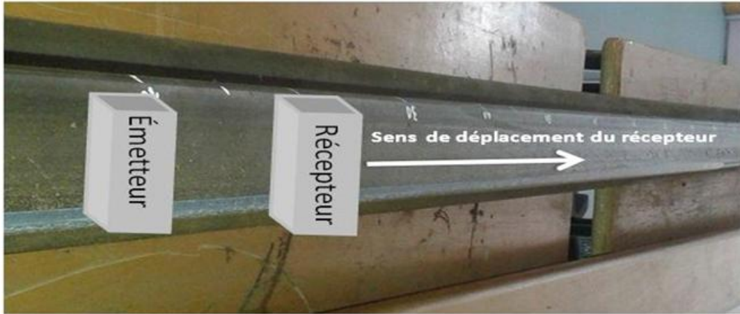
Figure 18 : Configuration des capteurs sur le rail pour déterminer expérimentalement la vitesse de propagation de l'onde de Rayleigh générée
