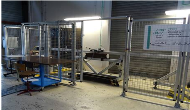
Figure 16 : Démonstrateur pour essais EMATs
