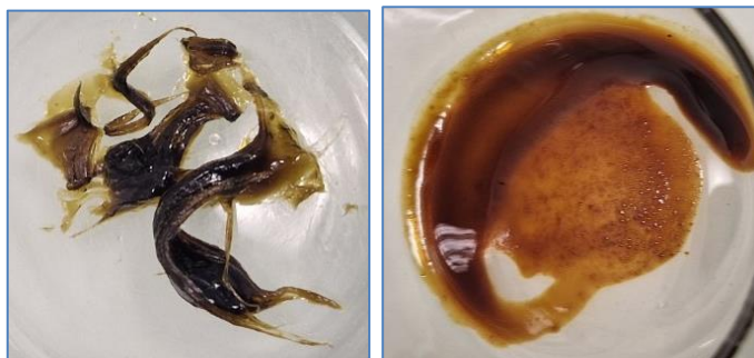
Figure 120 : Observation de résines avant (gauche) et après (droite) passage à l'étuve à 150°C
