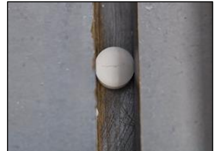
Figure 146 : Observation de la fracture diamétrale sur un des comprimés PROSOLV®+ Primellose + Aspartame+ Terpènes dans le duromètre
