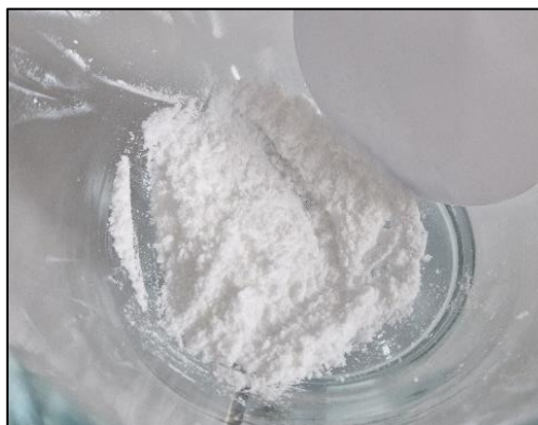
Figure 144 : Etat du mélange de terpènes + Aérosil 300 (silice colloïdale) après adsorption
