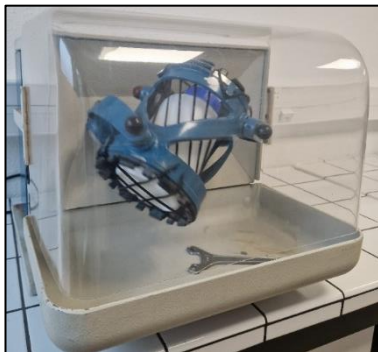
Figure 54 : Mélangeur Turbula avec le flacon contenant la formulation de CBD+ PROSOLV®
