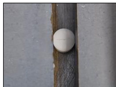
Figure 146 : Observation de la fracture diamétrale sur un des comprimés PROSOLV®+ Primellose + Aspartame+ Terpènes dans le duromètre
