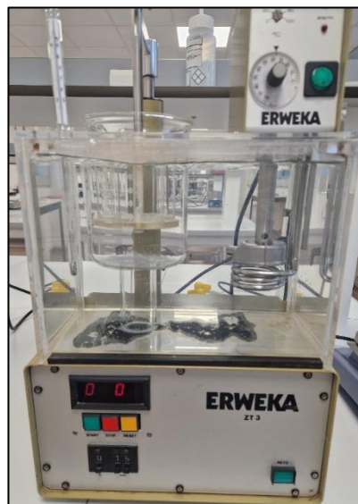
Figure 58 : Appareil de désagrégation Erweka ZT3
