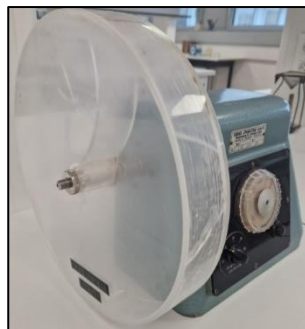
Figure 57 : Appareil de friabilité APPARATEBAU Erweka
