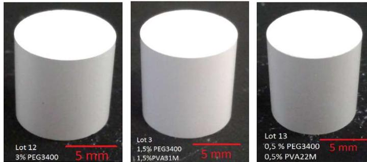
Figure 141 : Clichés de pastilles crues obtenues par pressage de granules de  $\text{TiO}_2\text{-Y}_2\text{O}_3$ . Gauche : 3 %mp PEG3400. Milieu : 1,5 %mp PEG3400 + 1,5 %mp PVA31M. Droite : 0,5 %mp PEG3400 + 0,5 %mp PVA22M.
