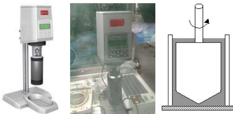
Figure 68 : Rhéomètre Rheolab QC hors (gauche) et en boîte à gants (milieu). Détail de la géométrie Couette (droite).
