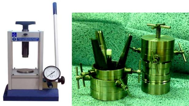
Figure 72 : Presse manuelle Specac Atlas 25 (gauche) et matrice tricoquille (droite).
