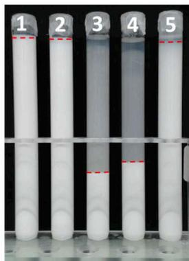
Figure 84 : Photographie des tubes de suspensions diluées de  $\text{TiO}_2\text{-Y}_2\text{O}_3$  contenant différentes proportions d'yttrium, après 24 h de sédimentation. Les numéros des tubes se réfèrent au Tableau 16. Les niveaux de surnageant sont repérés par des pointillés rouges.
