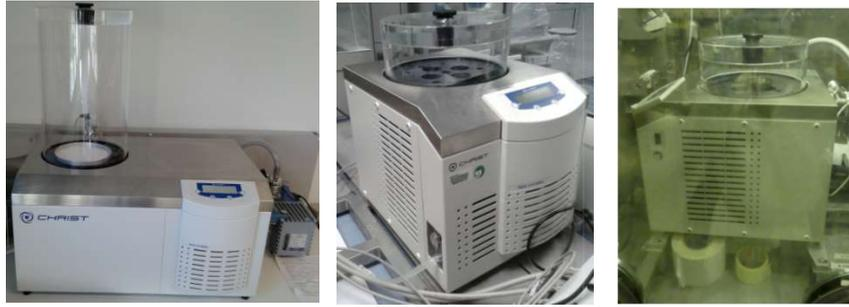
Figure 70 : Lyophilisateur utilisé en inactif (gauche), et lyophilisateur utilisé en actif, avant (milieu) et après (droite) installation en boîte à gants.
