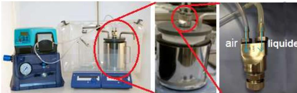
Figure 69 : Granulateur cryogénique complet (gauche), détails du vase d'atomisation (milieu) et de la buse d'atomisation (droite).
