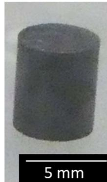
*Figure 153 : Pastille frittée d' $\text{UO}_2$  VSL –  $\text{PuO}_2$  M401 (15 % Pu) formée par le procédé de granulation cryogénique.*
