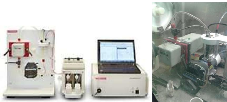
Figure 67 : Acoustophoromètre AcoustoSizer II hors (gauche) et en boîte à gants (droite).
