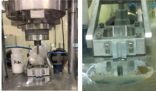
Figure 73 : Gauche : presse Osterwalder en boîte à gants (Atalante – laboratoire LN0). Droite : détail des outillages de la presse et pastille pressée d'UO<sub>2</sub>.
