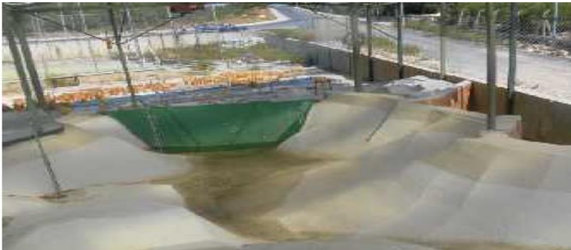
Figure 4. Modèle réduit de barrage d'Urkmez (Tayfur et al, 2013)
