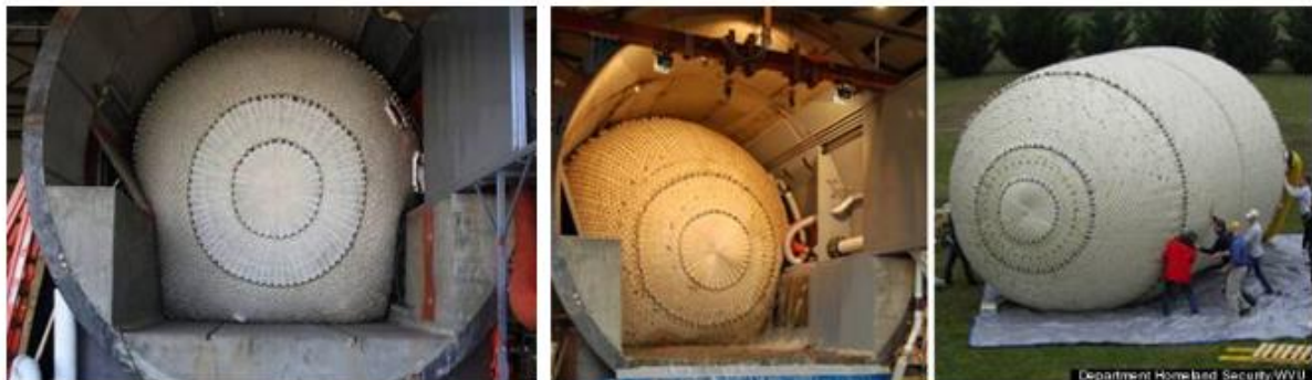
Figure III.E.9. Protection par obturateur gonflable.
