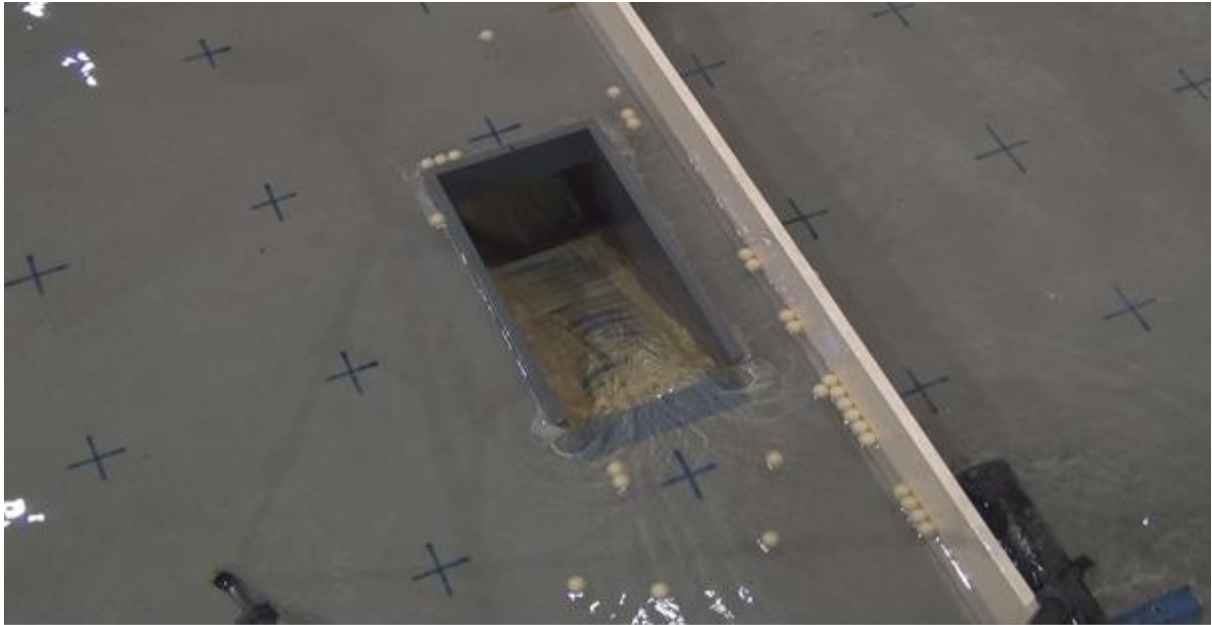
Figure 32. Ecoulement lors d'une configuration avec confinement 1 m à droite sans débordement avec la présence des billes de polystyrène.
