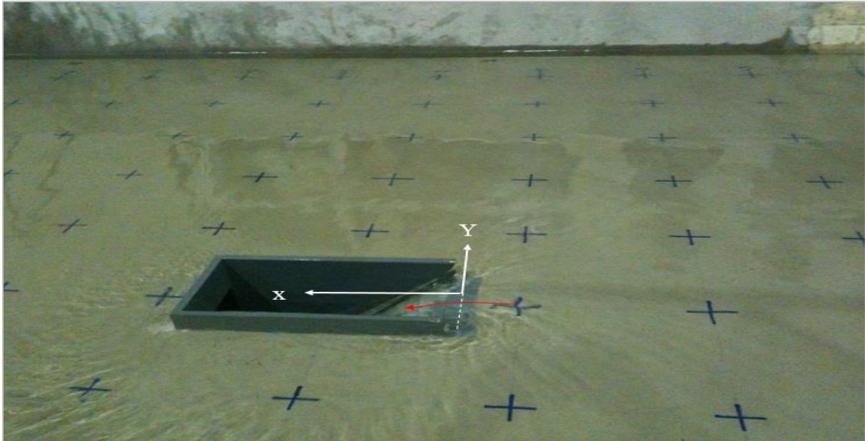
Figure 21. Ecoulement courbé sur le seuil d'accès à la bouche de métro. Configuration SB
