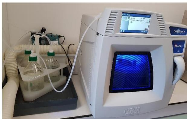
**Figure III. 6** : Système de micro-ondes CEM de type Mars 6
