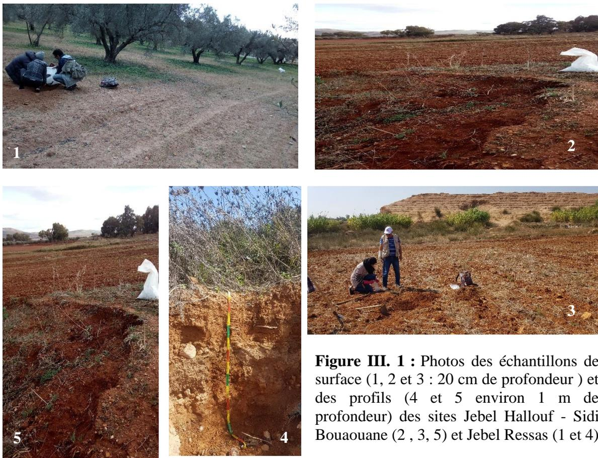
**Figure III. 1 :** Photos des échantillons de surface (1, 2 et 3 : 20 cm de profondeur) et des profils (4 et 5 environ 1 m de profondeur) des sites Jebel Hallouf - Sidi Bouaouane (2, 3, 5) et Jebel Ressas (1 et 4)
