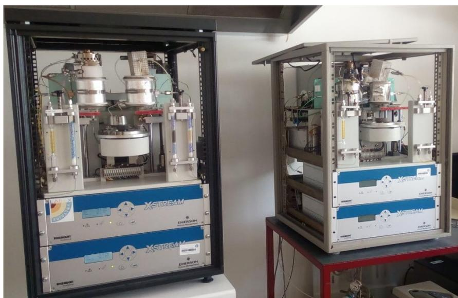
**Figure III. 4 :** Pyrolyseur Rock-Eval (X2)
