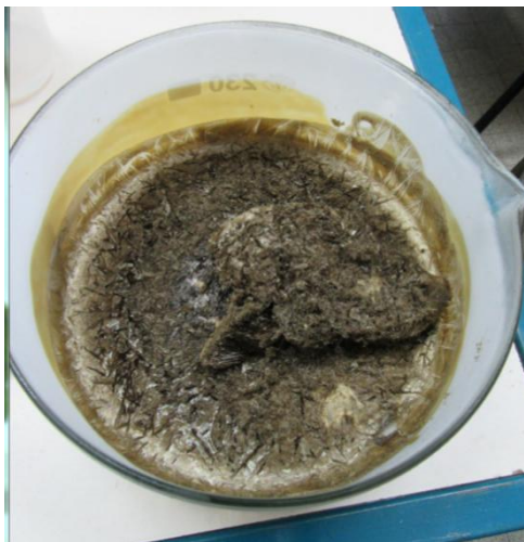
Photo 4 : l'OG après séchage présentant des zones plus lamellaires, plus claires ou plus foncées
