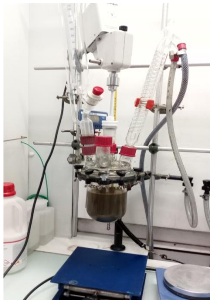
Photo 1 : Montage mis en place pour la synthèse de l'OG à relative grande échelle
