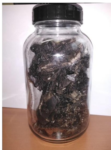
Photo 3 : oxyde de Graphene séché par lyophilisation
