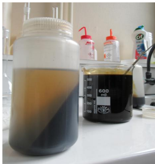
Photo 2 : Milieu réactionnel après lavages/centrifugations successifs avec HCl 3.7% et H 2 O.
