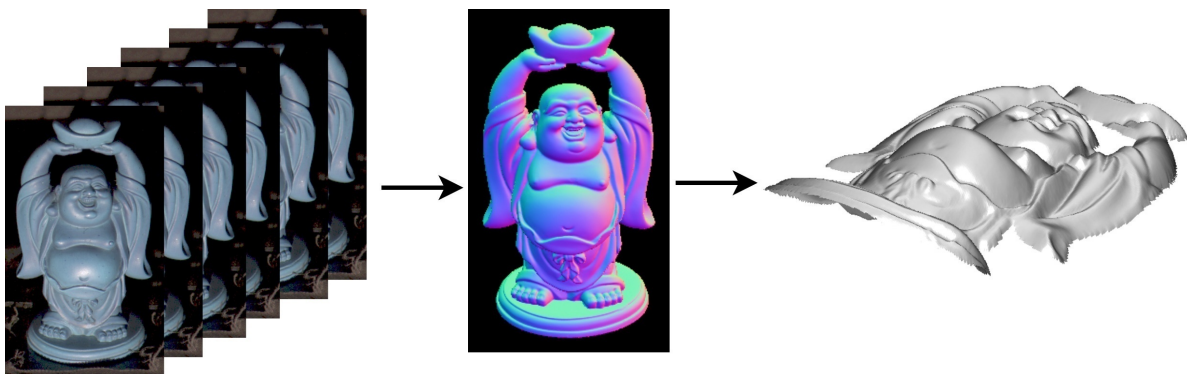
FIGURE 1.2 – Principe d’un algorithme de stéréophotométrie : la statuette est prise en photo sous différentes directions lumineuses. À l’aide de ces photos une carte de normales est estimée et par la suite, elle est intégrée pour obtenir un objet en 3D.
