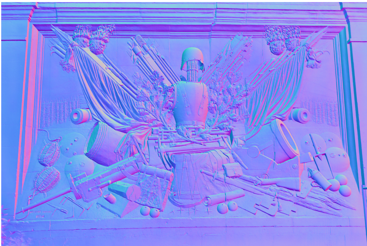
FIGURE 7.6 – Reconstruction de la carte des normales des hauts-reliefs de la caserne de Metz à l'aide de notre méthode universelle développée dans le chapitre 5.
