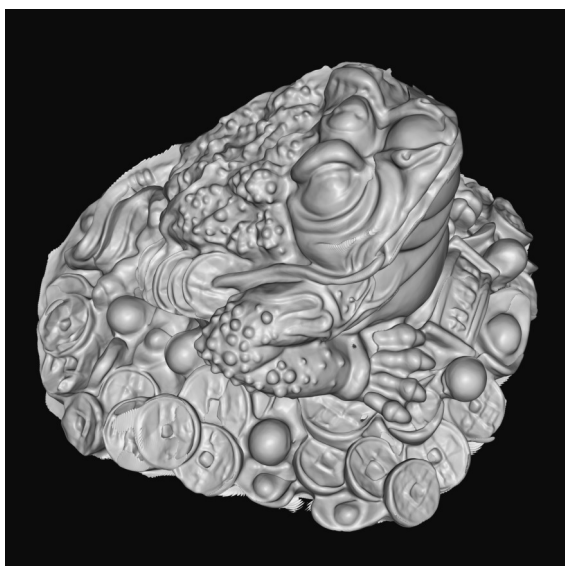
FIGURE 7.4 – Reconstruction 3D multi-vues de l'objet “ jin-chan ” du jeu de données [93]. RnB-Neus permet d'obtenir une reconstruction 3D beaucoup plus détaillée, précise et correcte des objets comparativement à Neus. Les pattes et pièces de monnaies sont notamment beaucoup mieux reconstruites.
