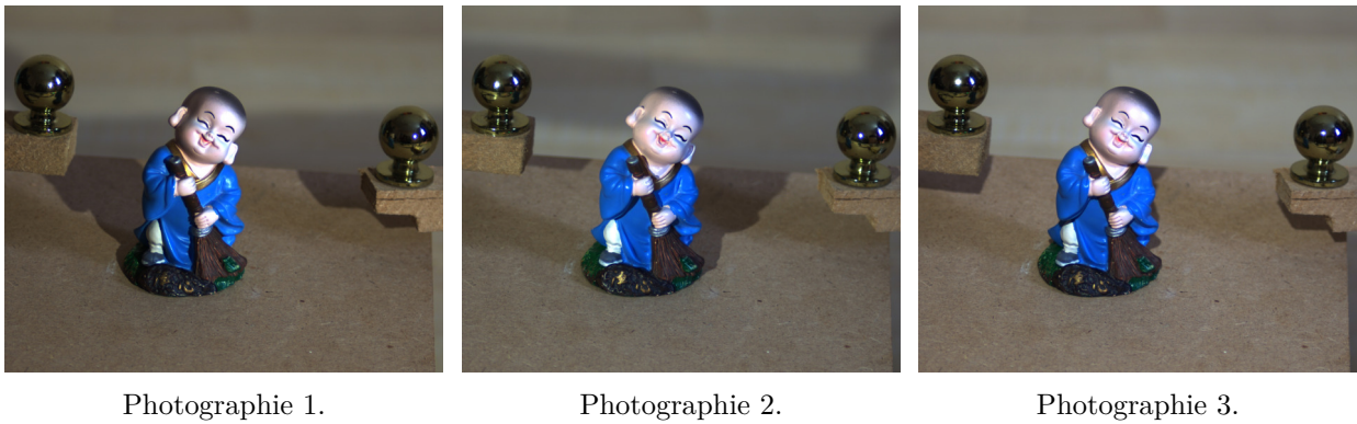
FIGURE 1.1 – Exemples d’acquisitions d’images de stéréophotométrie. Dans cet exemple, une statuette de Bouddha a été photographiée sous trois éclairages différents : la lumière vient de la droite sur la première photographie, de la gauche sur la deuxième et de face sur la dernière.
