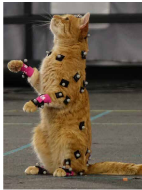
FIGURE 2.8 – Exemple de capture de mouvements par marqueurs optiques passifs Vicon
