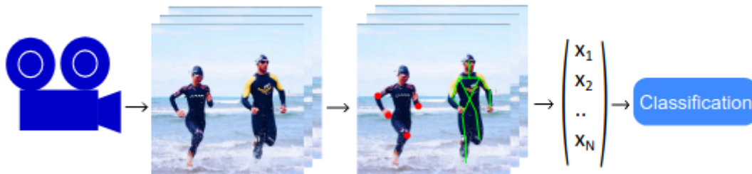
FIGURE 2.9 – Exemple de pipeline pour la reconnaissance d’actions à partir de squelettes [59]
