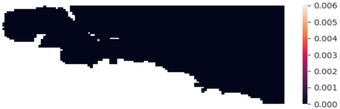
FIGURE III.6 – Temps de calcul en secondes. Chaque petit rectangle non blanc représente un sous-domaine MPI de la simulation. Le temps de calcul d'un tronçon délimité par la fin d'un appel à la routine de communication d'une part et le début de l'appel suivant d'autre part est affiché. Ce tronçon est sélectionné au cours de l'exécution d'une simulation de l'Atlantique Ouest utilisant 3851 cœurs.
