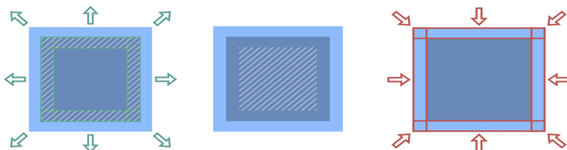
FIGURE IV.19 – Schéma explicatif du schéma de communication avec recouvrement communication-calcul. Les trois étapes sont représentées de gauche à droite, premièrement, à gauche, le calcul sur les zones hachurées dont les différentes sections encadrées en vert sont ensuite envoyées aux voisins. Deuxièmement, au milieu, le calcul sur le reste de l'intérieur du domaine, sur la zone hachurée. Troisièmement, à droite, la phase bloquante de la réception des messages.
