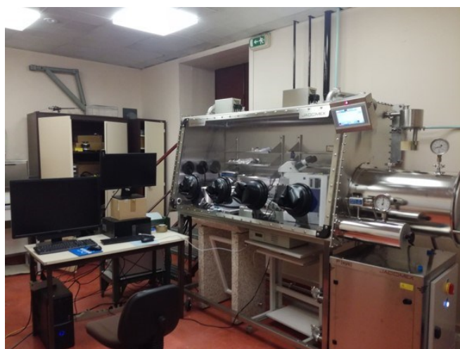
FIGURE II.4 – Photographie de la boîte à gants instrumentée du LEM dans laquelle est intégré le dispositif d'assemblage des hétérostructures de matériaux 2D.
