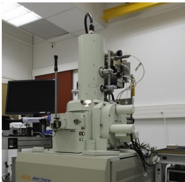
FIGURE II.9 – Microscope électronique du GEMaC – JEOL7001F équipé d'un canon à électrons à émission de champ (pointe Schottky).
