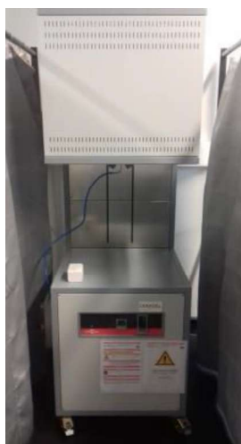
Figure II.1 : four ascenseur utilisé pour la cuisson de \text{Ca}_2\text{SiO}_4 et des clinkers.
