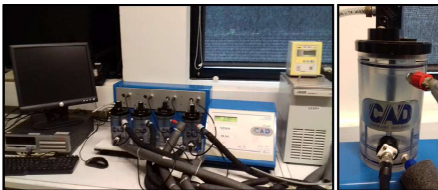
Figure II.5 : montage des mesures de conductivité et image de la cellule de mesure utilisée.
