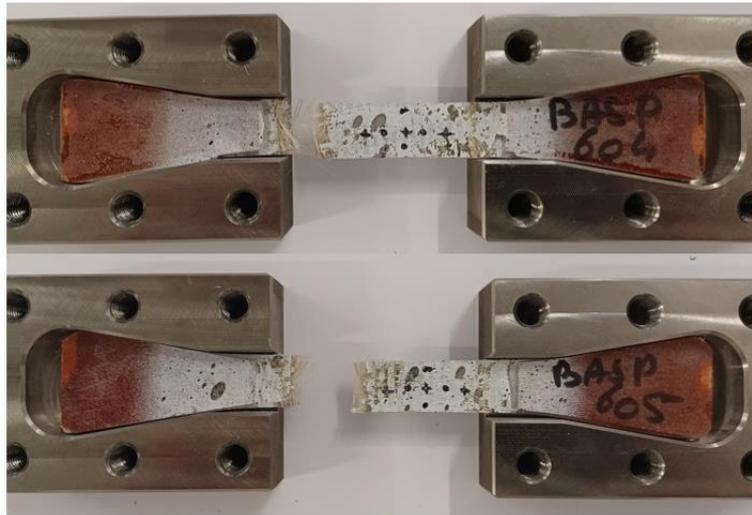
Figure 281 Modes de ruptures des composites Basalte/PA11 [90°]<sub>8</sub> pour des vitesses de déformation moyennes comprises entre 111 s<sup>-1</sup> et 125 s<sup>-1</sup>
