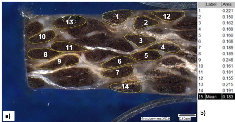
Figure 156 (a) Microstructure d'un composite Lin/PA11 (0°) révélée par microscopie optique, (b) identification de la surface des fibres techniques de lin imprégnées (mm<sup>2</sup>)
