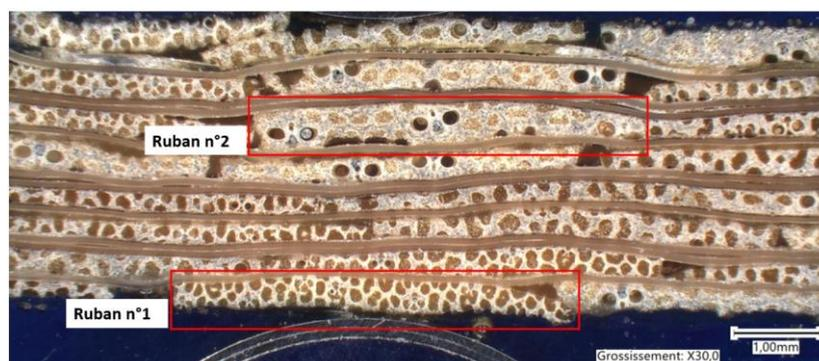
Figure 132 Microstructure d'un composite Bambou/ELIUM (0°) révélée par microscopie optique et localisation des rubans étudiés
