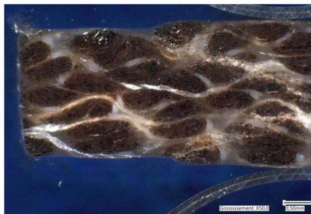
Figure 119 Microstructure d'une Lin/PA11 (0°) révélée par microscopie optique, grossissement x 50
