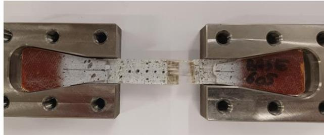
Figure 279 Mode de rupture du composite Basalte/ELIUM  $[90^\circ]_8$  pour une vitesse de déformation de  $138 \text{ s}^{-1}$
