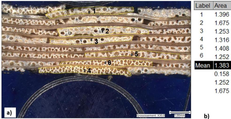
Figure 155 (a) Microstructure d'un composite Bambou/ELIUM (0°) révélée par microscopie optique, (b) identification de la section des rubans (mm<sup>2</sup>)
