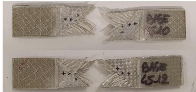
Figure 289 Modes de ruptures des composites Basalte/ELIUM [(45/-45)<sub>2</sub>]<sub>s</sub> pour des vitesses de déformation moyennes comprises entre 108 s<sup>-1</sup> et 129 s<sup>-1</sup>
