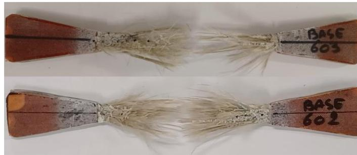
Figure 272 Modes de ruptures des composites Basalte/ELIUM  $[0^\circ]_8$  pour des vitesses de déformation moyennes comprises entre  $69 \text{ s}^{-1}$  et  $74 \text{ s}^{-1}$
