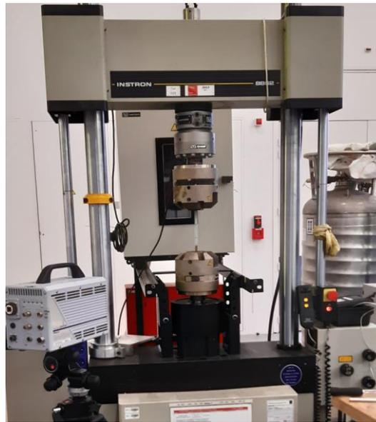
Figure 138 Machine d'essai INSTRON 8862 avec une éprouvette composite 8 plis 0° de Lin/PA11
