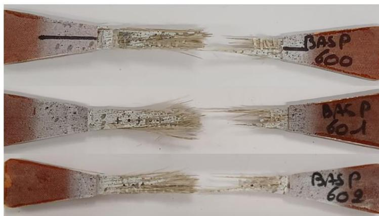
Figure 274 Modes de ruptures des composites Basalte/PA11  $[0^\circ]_8$  pour des vitesses de déformation moyennes comprises entre  $69\text{ s}^{-1}$  et  $74\text{ s}^{-1}$
