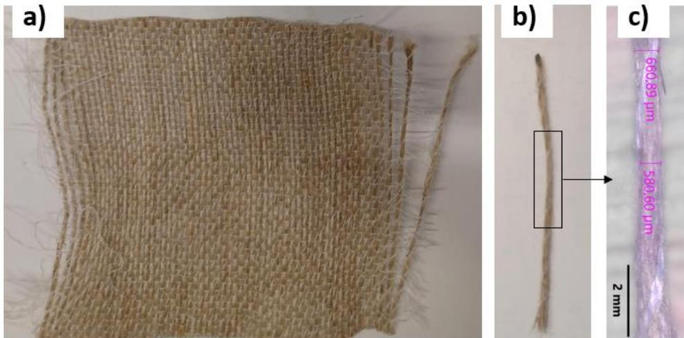
Figure 110 (a) Vue d'un unidirectionnel de Lin 360 gsm, (b) fibre technique de Lin, (c) mesure de la section
