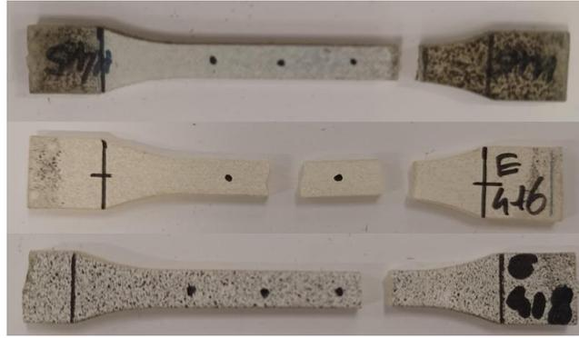
Figure 237 Modes de ruptures des éprouvettes d'ELIUM pour des vitesses de déformation moyennes comprises entre  $29 \text{ s}^{-1}$  et  $37 \text{ s}^{-1}$
