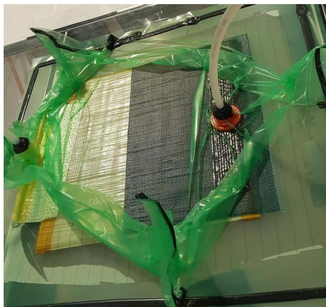
Figure 122 Fabrication par infusion du composite Bambou/ELIUM
