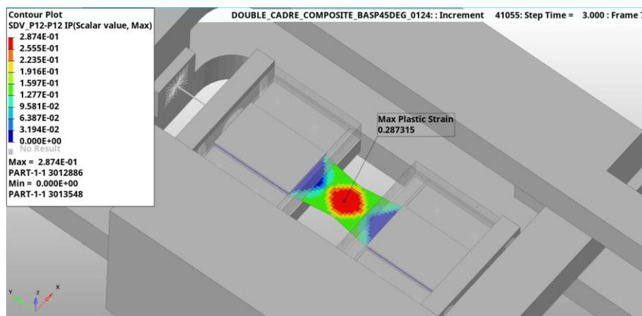
Figure 233 Simulation numérique avec VUMAT des essais dynamiques rapides sur composites Basalte/PA11  $[(45/-45)_2]_s$  avec le montage double cadre, visualisation du champ de déformation plastique cumulée à  $t=3$  ms
