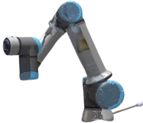
FIGURE 5.8 – Projection de l'image omnidirectionnelle sur le modèle 3D de l'objet d'intérêt. L'image omnidirectionnelle texture le modèle 3D du cobot aux régions qui ont été visibles par la caméra, la couleur par défaut du modèle est utilisée aux autres régions.
