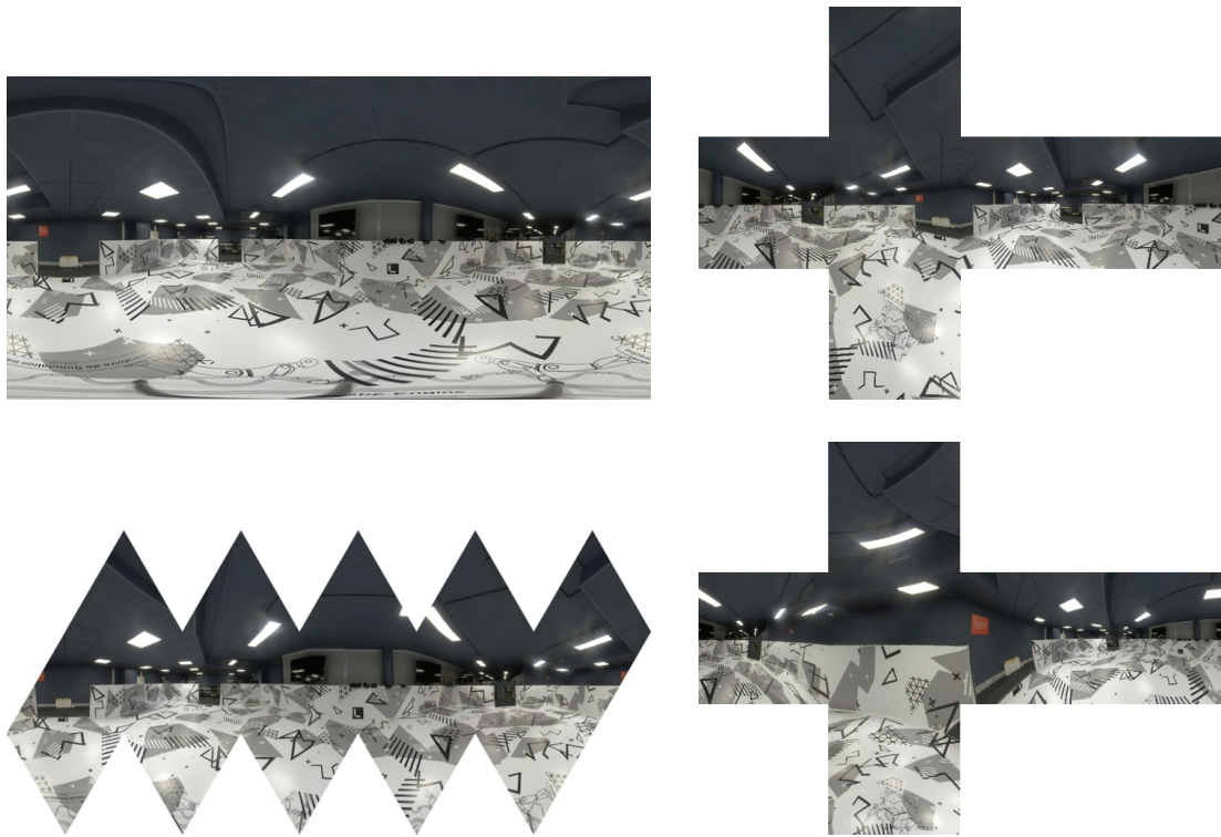
FIGURE 3.2 – Projections d’une image omnidirectionnelle. Haut-Gauche : Projection équirectangulaire. Haut-Droite : Projection cubemap . Bas-Gauche : Projection en patches sur un icosaèdre ( ISP ). Bas-Droite : Projection offset-cubemap .
