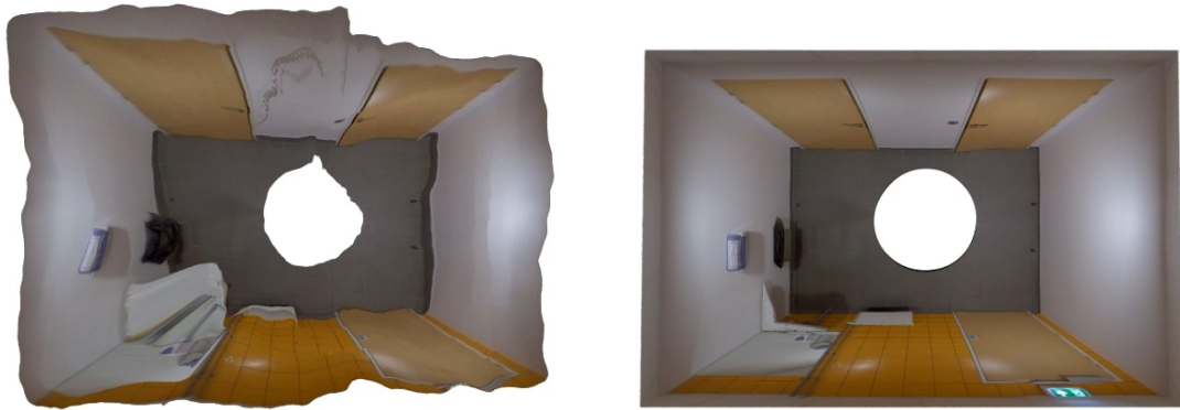
FIGURE 4.6 – Approches pour l’estimation de profondeur. Les images correspondent aux reconstructions 3D obtenues avec les différentes cartes de profondeur. Gauche : Estimation directe de la carte de profondeur. Droite : Estimation de l’agencement.
