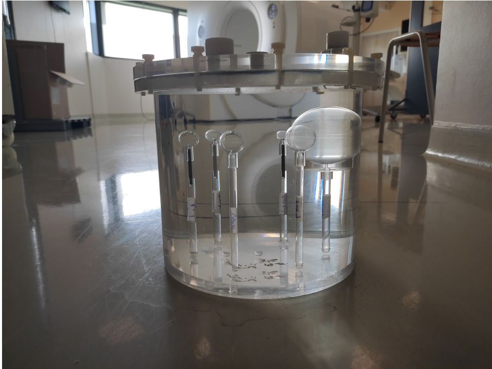
FIGURE 4.4 – Fantôme cylindrique d'un volume de 6716 mL, dans lequel sont insérées six sphères de volumes différents (114,85 mL, 16,28 mL, 8,01 mL, 4,18 mL, 2,06 mL, et 0,5 mL). Les mesures sont réalisées sur la caméra INTEVO Bold de Siemens.
