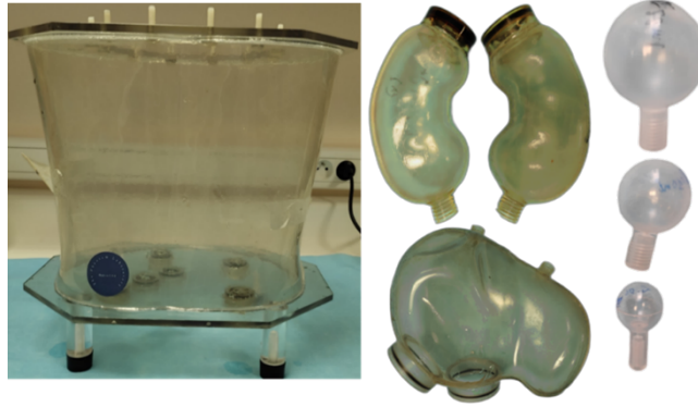
FIGURE 4.1 – Fantôme Liqui-Fil et ses objets tests : à gauche l’abdomen, et à droite, les inserts représentant les reins et le foie ainsi que 3 sphères mimant les tumeurs.
