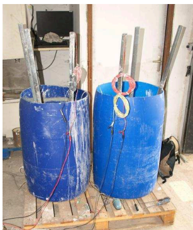
FIGURE 2.14 – Piles benthiques in-situ dans l'usine Nikkal
