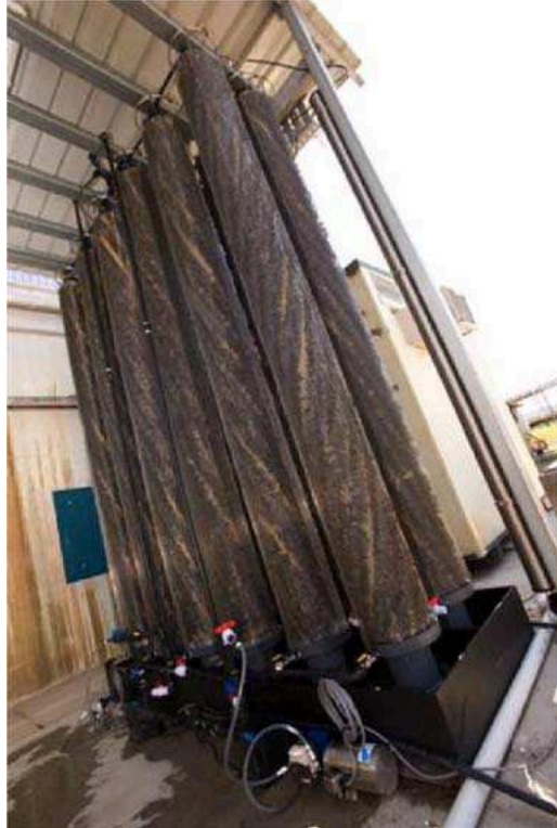
FIGURE 1.8 – Pile à combustible microbienne tubulaire utilisant l'eau usée de la brasserie Foster à Yatala en Australie.
