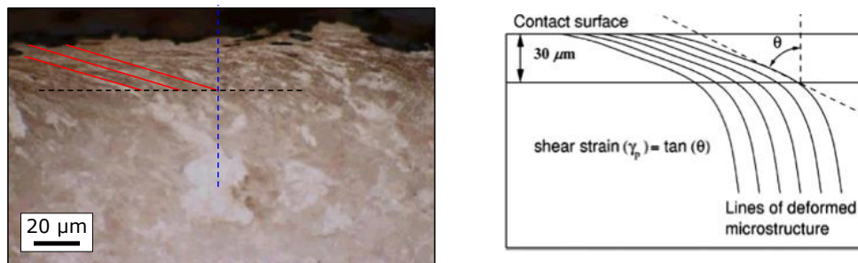
Figure A.6 – Principe de l'estimation de la déformation plastique de la microstructure, Alwahdi et al. (2013).
