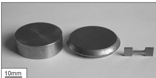
Figure A.9 – Échantillons neuf et déformé par l'essai HPT et une éprouvette de traction extraite d'un échantillon, Larijani et al. (2015).
