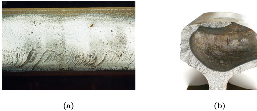
Figure A.4 – (a) Défauts de Head Check sur le congé actif d'un rail, (b) Propagation d'une fissure de Head Check dans la tête de rail, Dollevoet (2010).
