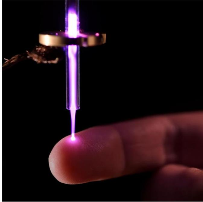
**Figure 26 : Le plasma froid atmosphérique** <sup>215</sup>. Le CAP ressemble à un faisceau de lumière généré à partir de l'ionisation partielle d'un gaz à basse température, ce qui le rend applicable dans de nombreux domaines biomédicaux.
