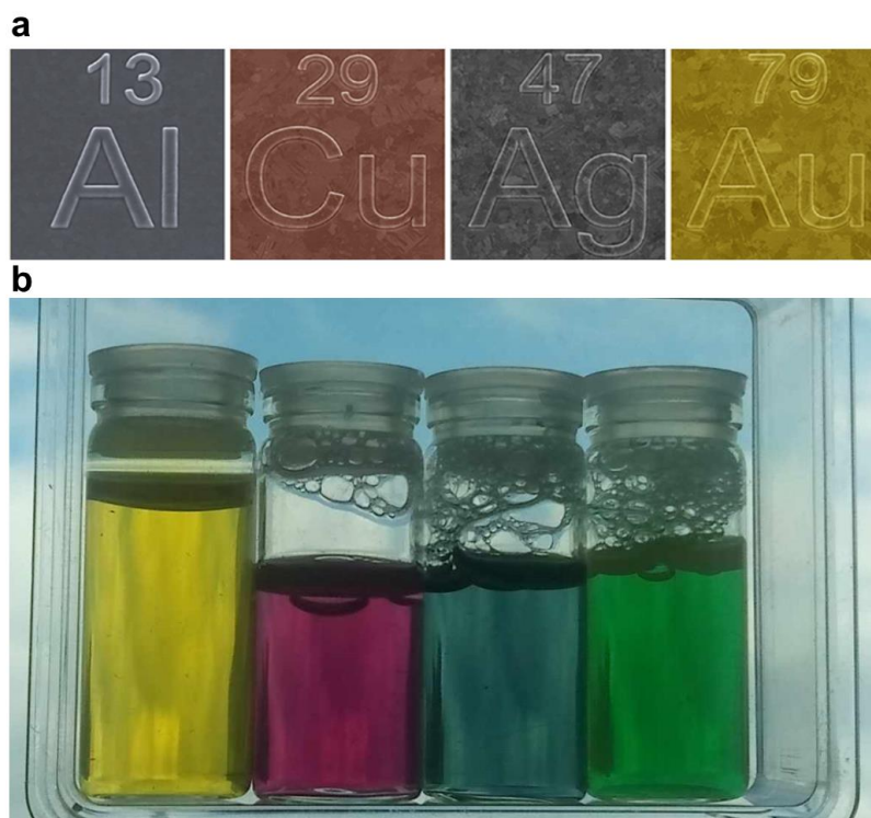
Figure I-1 (a) Couleurs usuelles et numéros atomiques des métaux plasmoniques à l'état massif. (b) Solutions colloïdales de NPs fabriquées au laboratoire. De gauche à droite : nanosphères d'argent, nanosphères d'or, nanobâtonnet d'or de faible rapport d'aspect, nanobâtonnets d'or recouverts d'argent.
