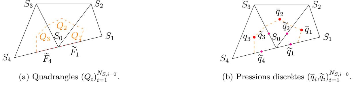
FIGURE 4.5 – Schéma MPFA pour  $j \in \mathcal{T}_S^b$  et  $N_{S,i=0} = 4$
