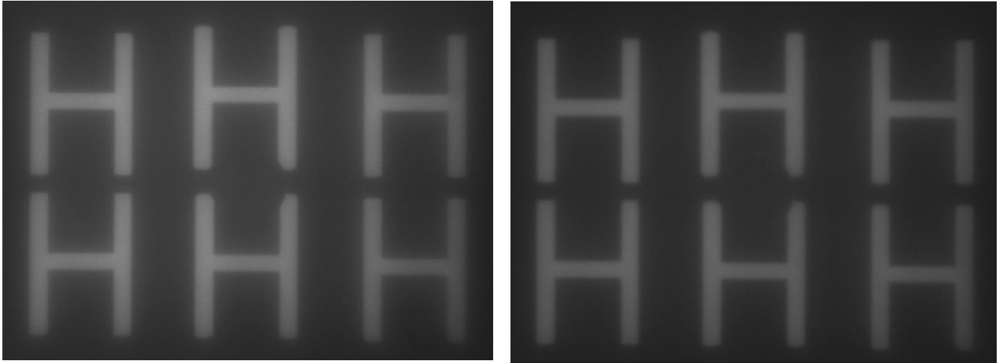
Figure 48 : Scène de référence – sans filtre et avec filtre devant le capteur et sans éblouissement par le laser
