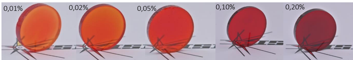
Figure 61 : Filtres optiques – matrice SR/CN – Disperse Red 13 – [wt%] 0,01 à 0,20 de gauche à droite
