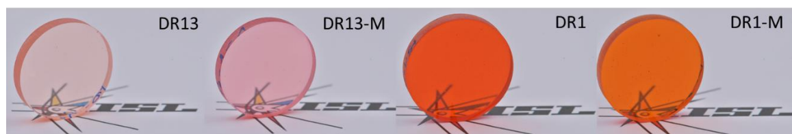
Figure 105 : Filtres obtenus par impression 3D après polissage – DR13 , DR13-M , DR1 et DR1-M à 0.01%wt d'additif
