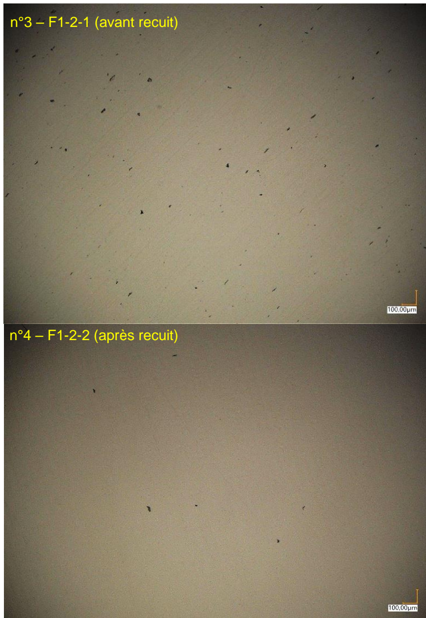
Figure 104 : Observation au microscope optique des filtres F1-2 après polissage (avant et après recuit 1h – 175°C) – Echelle 100 µm = 0,5 cm
