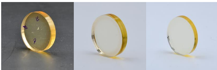
Figure 33 : Filtres optiques – système MMA / PBO – DMA
