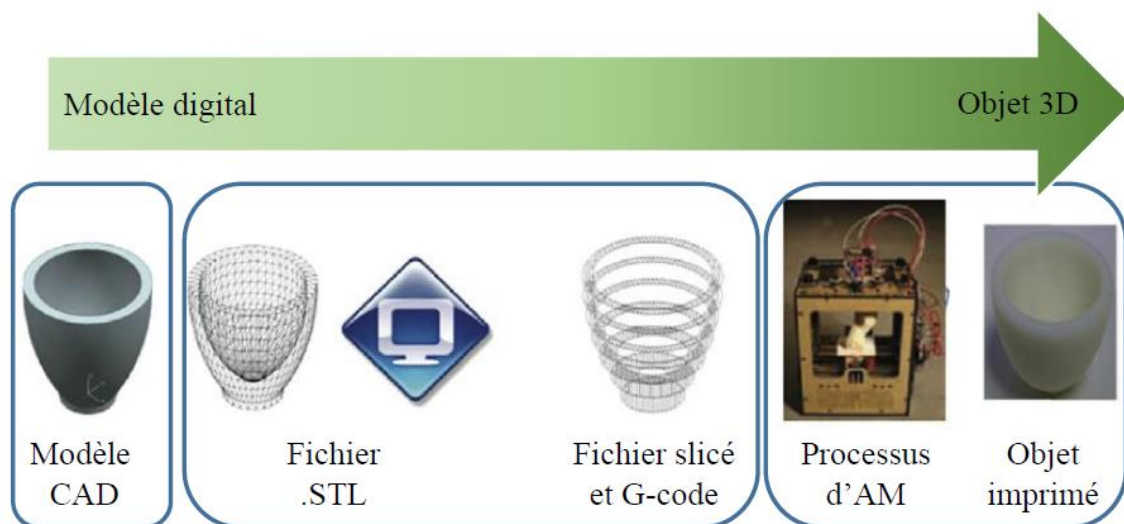
Figure 27 : Processus d'impression 3D
