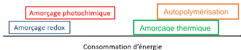
Figure 23 : Consommation qualitative en énergie d'une réaction de polymérisation selon la voie d'amorçage choisie 61
