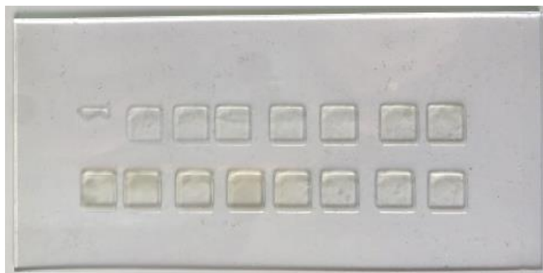
Figure 41 : Plaque obtenue suite à l'exposition de la résine pendant différents temps croissants (gauche --> droite 1ère ligne – 0,5 s à 4 s / droite --> gauche 2nd ligne – 4,5 s à 8 s)
