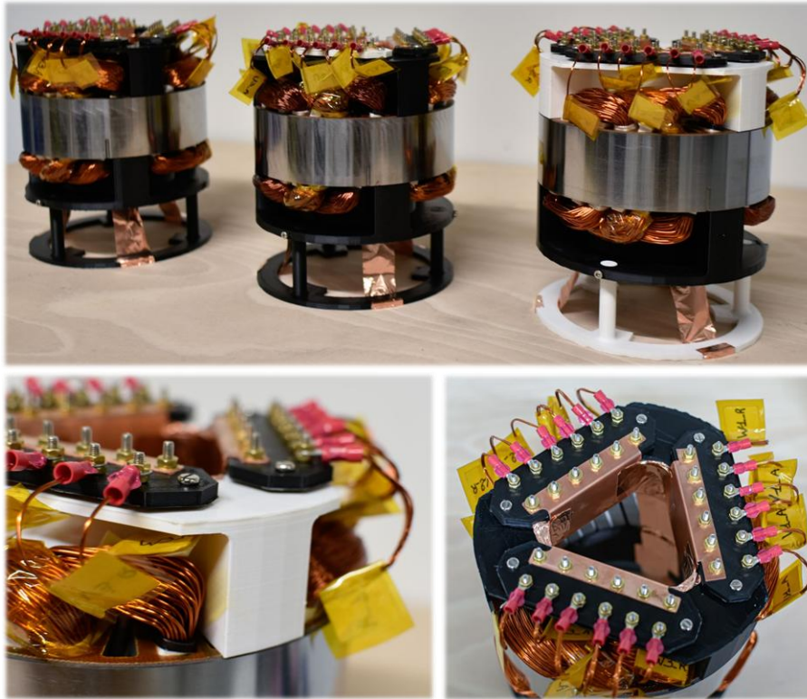
Figure III-4 – Maquettes de stator assemblées avec le système de mise à la terre
