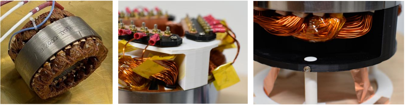
Figure II-15 – Exemple de tête de bobine sur un stator assemblé et les maquettes de validation
