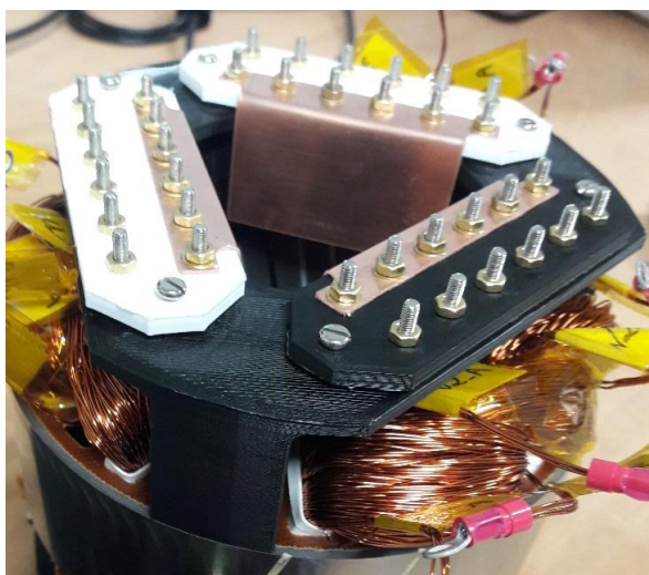
Figure III-5 – Zoom sur le système de mise à la masse du paquet de tôles et des points de mesures d'impédance
