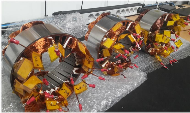
Figure III-2 – Maquettes de stator reçues après spécification
