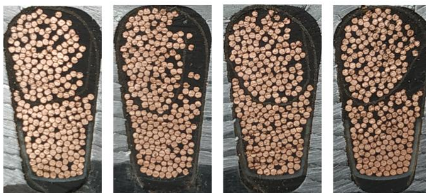
Figure II-8 – Vue de coupe d'encoches avec deux enroulements, affichant différentes répartitions de bobinages [109]
