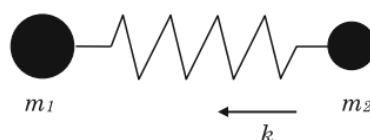
Figure II-2 : Modèle de l'oscillateur harmonique idéal reliant deux masses m_1 et m_2 par un ressort.
