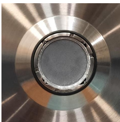
Figure II-24 : Photo d'un film de poly-L-proline préparé par Spin coating sur un substrat de silicium poli simple face installé sur le porte échantillon du dispositif CIGALE
