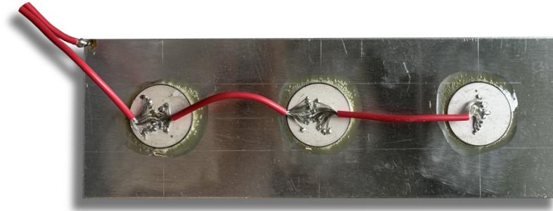
Figure III-27 Photographie de la plaque avec les trois actionneurs collés d'en dessous.
