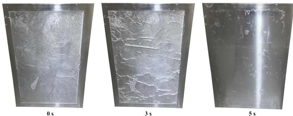
Figure III-30 Résultats de dégivrage au 7<sup>e</sup> mode d'extension – [Essai N° 3](#).
