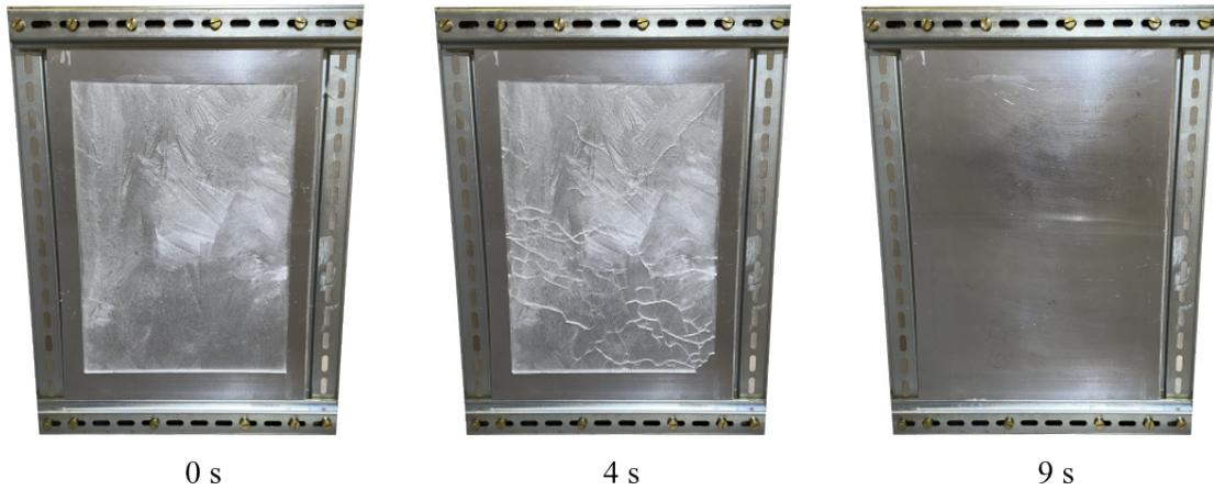
Figure III-36 Résultat de dégivrage avec l'éprouvette encastrée – [Essai N° 5](#).
