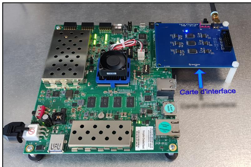
Figure V-9 Carte d'interface et d'isolation.
