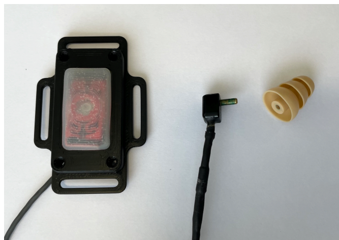
Figure 4.3 – Transducteur à gauche, sonde microphonique avec le bouchon d'oreille utilisé pendant l'expérience à droite.
