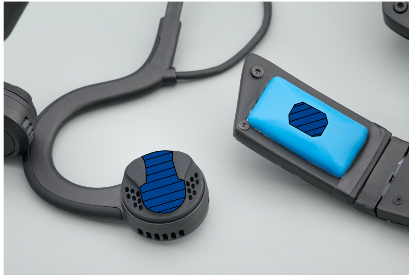
Figure 1.3 – Interfaces des transducteurs T_1 (à gauche) et T_2 (à droite). Les surfaces de vibration sont hachurées en bleu foncé.
