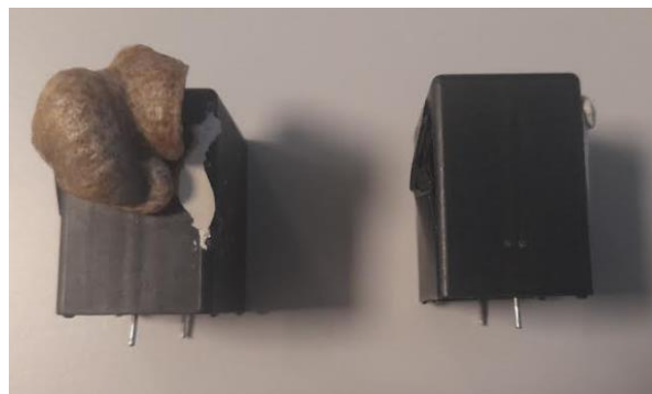
Figure 4-13 : Photographie d'un condensateur ayant subi un emballement ininterrompu face à un dont l'emballement a été stoppé.
