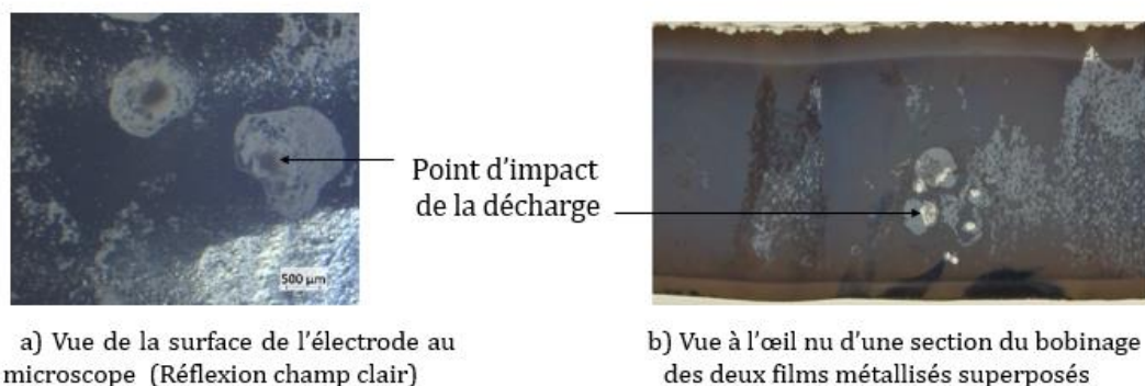
Figure 3-9 : Signes de décharges électriques sur les films métallisés du condensateur 3B_110°C-1,3U n
