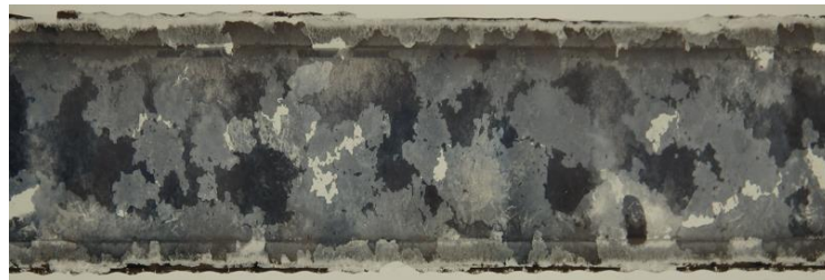
Figure 1-16 : Photographie de deux films métallisés superposés corrodés
