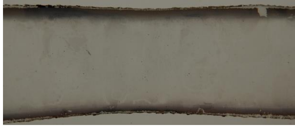
Figure 4-18 : Photographie de deux films métallisés superposés du condensateur 5C_95°C-85%-1U n après l'évènement de la figure 4-17
