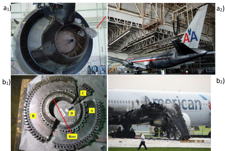
Figure A-3 : 1) Photo de disque de turbine éclaté et 2) dégâts engendrés sur les vols du a) 2 juin 2006 à Los Angeles; b) du 28 octobre 2016 à Chicago [NATI06, NATI18]
