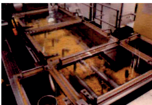
Figure II.4.2.2. Photo d'un équipement de mélange mécanique à l'échelle industrielle (Cuq, 2016. Technologie du couscous : du blé dur à la graine de couscous. Document support de cours. Montpellier SupAgro)
