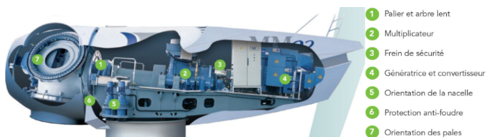
Figure 7.2: Schéma en coupe d'une éolienne de la technologie de turbine M
