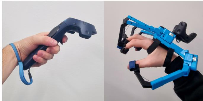
**Figure 64** – Gants de rétroaction [192]
