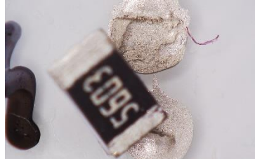
Figure 18 Composant déplacé après surmoulage.
