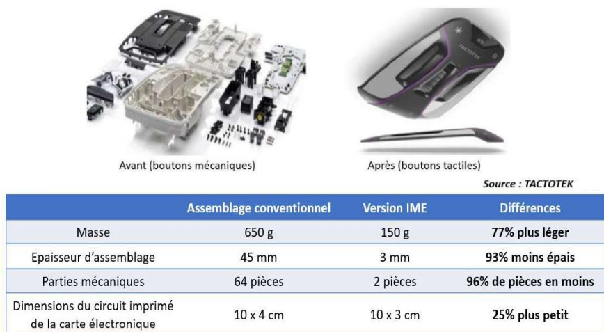
Figure 4 Comparaison entre une IHM en électronique conventionnelle et le même dispositif réalisé via ESS, d'après Tactotek. [4]
