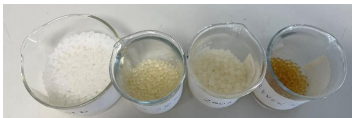
Figure 85 colorations des granulés de PLA, de gauche à droite, 3251D (1,6 % iso-D), renew 804 (4 % iso-D), 2003D (4,5 % iso-D) et Renew 212 (12,9 % iso-D).
