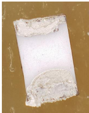
Figure 108 Faciès de rupture après pelage de la colle ME902.
