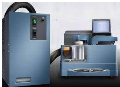
Figure 48 Appareil de mesure DSC TA instruments Q20 [99].
