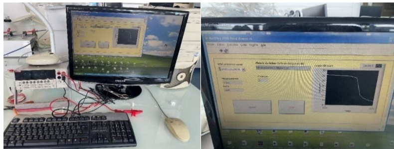
Figure 66 Appareillage d'acquisition des mesures de résistance.
